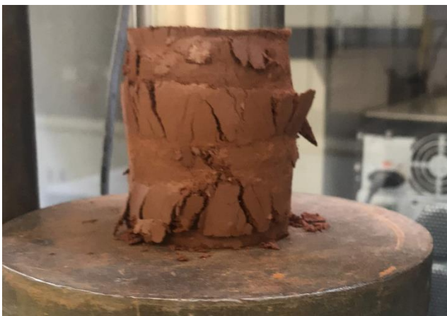
Figura 22: Corpo de prova de solo sem aquecimento com adição de PET durante ensaio de compressão simples
