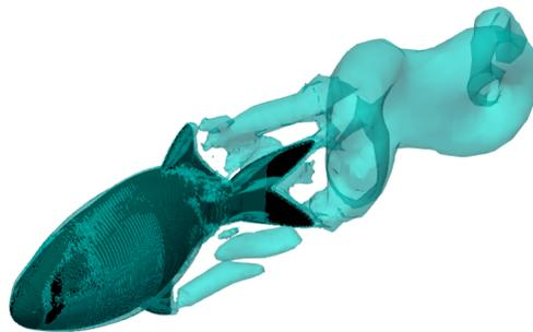
Figura 68: Representação 3D dos vórtices no caso do lambari com  $Re = 120\ 000$  e  $St = 0.2$
