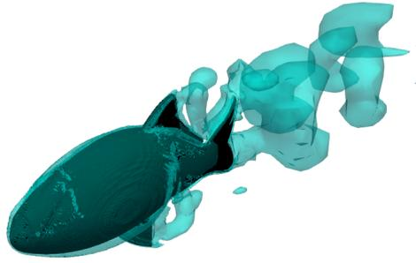
Figura 57: Representação 3D dos vórtices no caso do lambari com  $Re = 12\ 000$  e  $St = 0.6$
