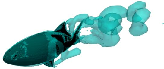
Figura 70: Representação 3D dos vórtices no caso do lambari com  $Re = 120\ 000$  e  $St = 0.4$
