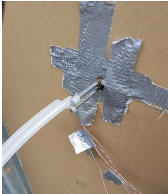
Figura 6.9. Mangueira da sonda bidirecional derretida na cota de 600 mm .
