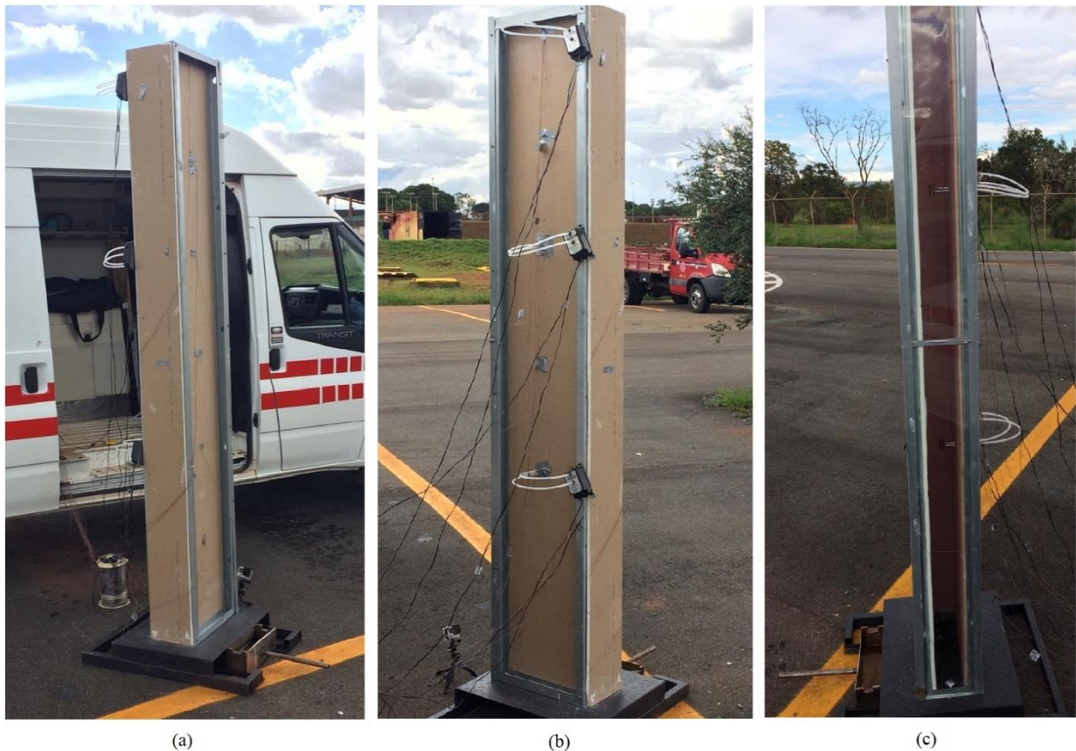
Figura 5.11. Instrumentação completa com os termopares e sondas bidirecionais. Em (a) foto da seção com drywall, em (b) posicionamento dos transdutores conectados por meio de mangueiras de 3/16" de diâmetro interno, e em (c) a seção com o vidro juntamente com o posicionamento das duas sondas bidirecionais inferiores.
