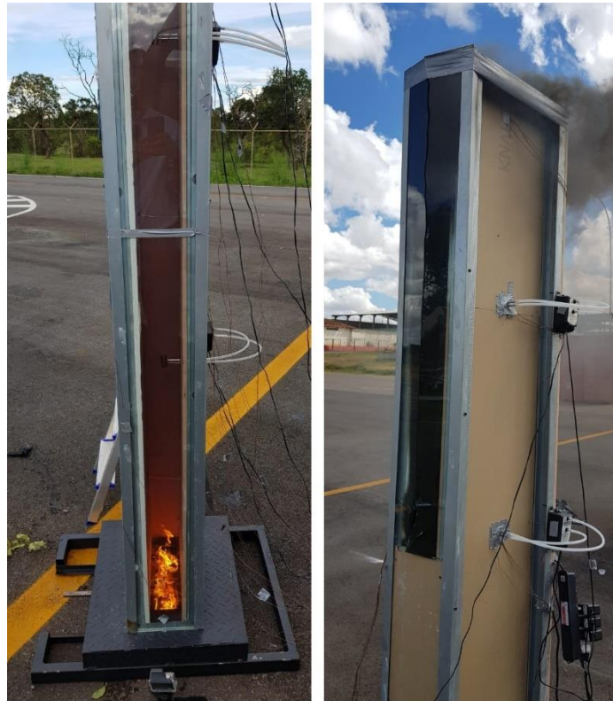
Figura 6.2. À esquerda o vidro na seção inferior quebrado após o primeiro experimento do caso 1, e já à direita o vidro superior quebrado após o terceiro experimento do caso 1.
