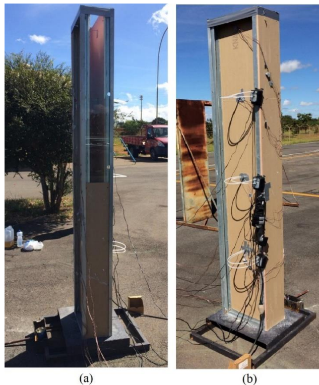
Figura 5.13. Bancada montada com a instrumentação pronta. Em (a) uma vista com a lateral de vidro pós instrumentação e em (b) a parte do duto com os transdutores ligados na sonda bidirecional e na fonte de energia posto no próprio duto.
