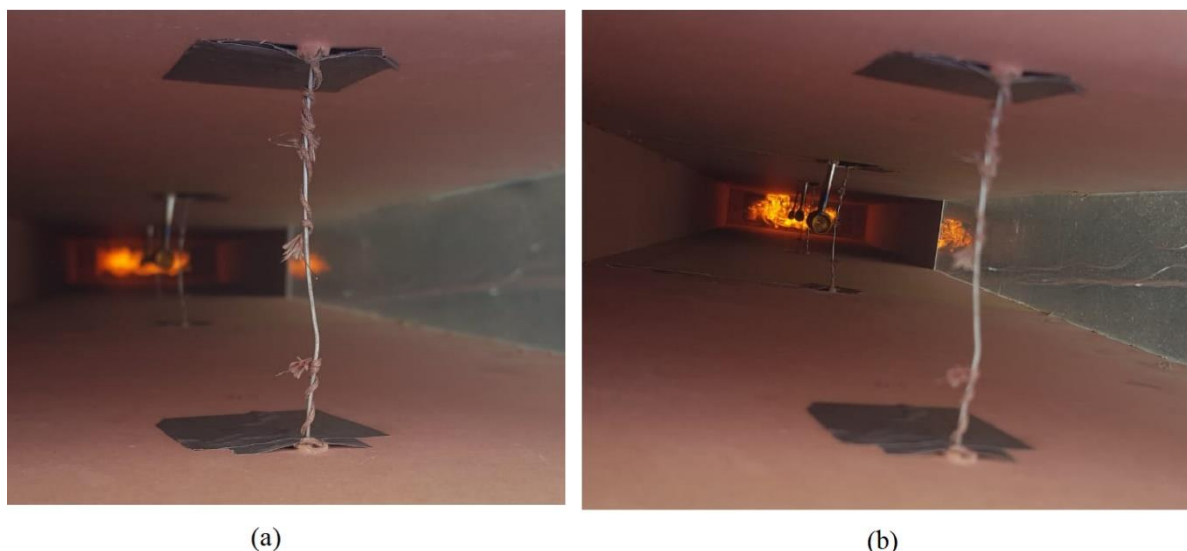
Figura 5.15. Instrumentação com vista superior durante a queima. Em (a) o foco está nos termopares na última altura do duto e em (b) o foco está na parte mais inferior do duto com as 3 sondas bidirecionais inferiores.
