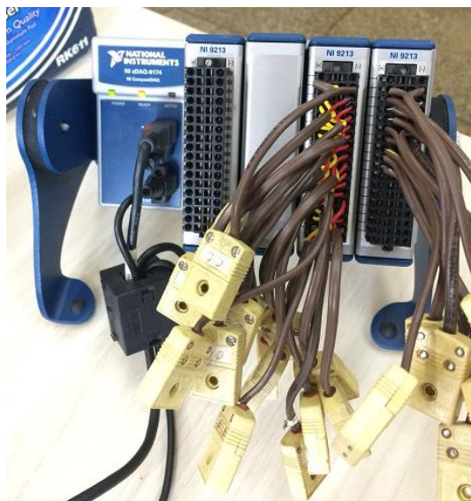
Figura 5.5. Sistema de aquisição dos dados de temperatura com o chassi CompactDAQ com entrada USB para computador e os módulos de entrada de temperatura NI 9213 conectados aos conectores fêmeas para entrada dos conectores machos dos termopares.
