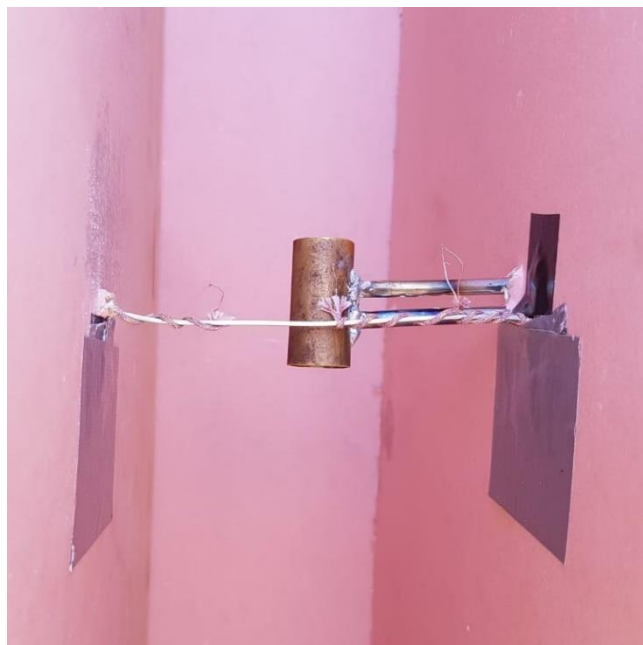
Figura 5.14. Instrumentação dos termopares centrais junto com os termopares na parede interna e a sonda bidirecional no centro.
