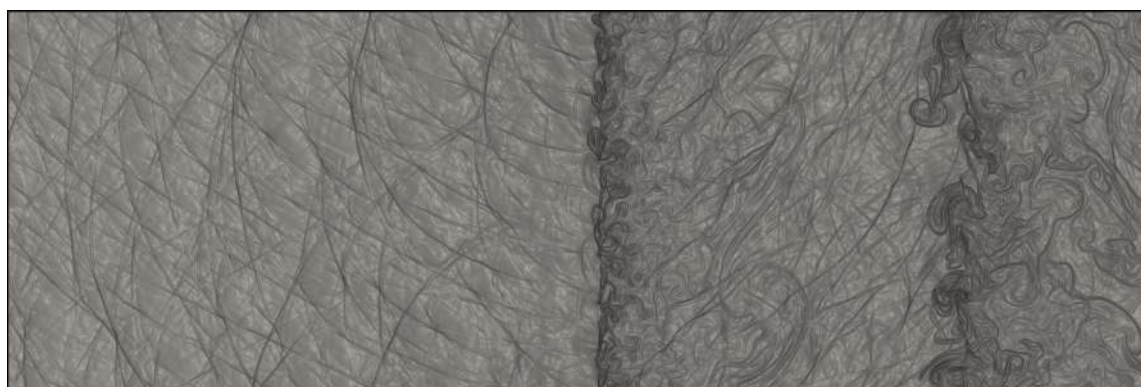
Fig. 4.5.5: Falha na simulação do Caso 01. Estol na primeira e segunda cascata.
