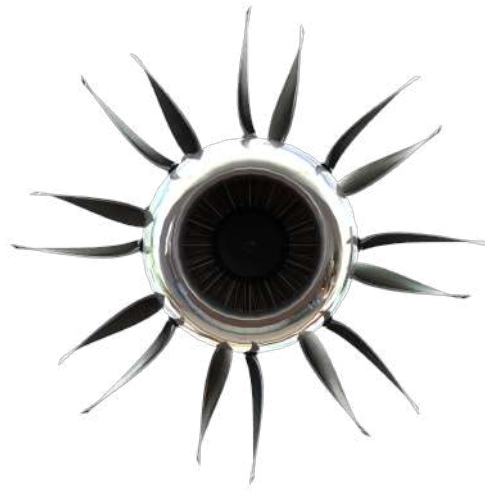
Fig. 3.10.3: Vista traseira do open rotor de pás contra-rotativas.
