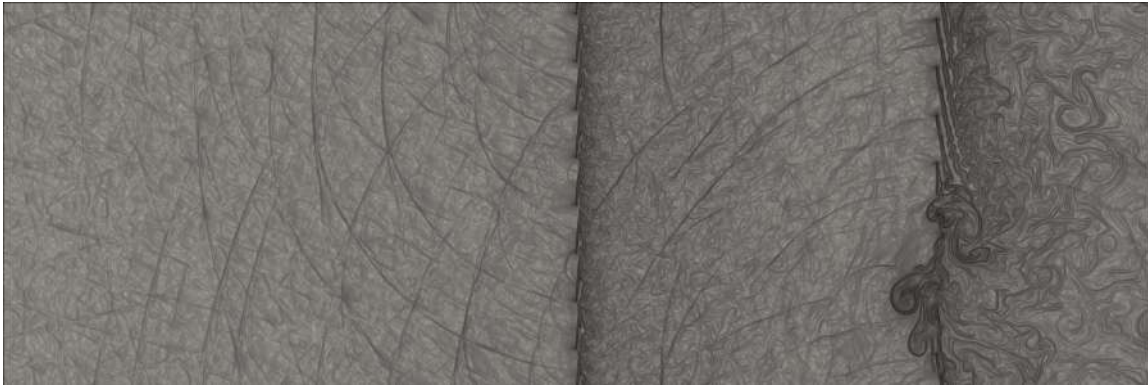
Fig. 4.5.7: Falha na simulação do Caso 03. Estol na primeira e segunda cascata.
