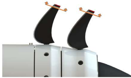
Fig. 3.10.1: Seção de corte para obtenção das geometrias bidimensionais.
