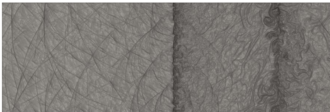
Fig. 4.5.6: Falha na simulação do Caso 02. Estol na primeira e segunda cascata.
