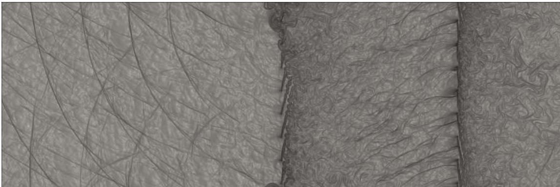
Fig. 4.5.15: Falha na simulação do Caso 10. Estol na primeira e segunda cascata.
