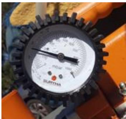
*Figura 69 - Medida do Vácuo no experimento 1*
