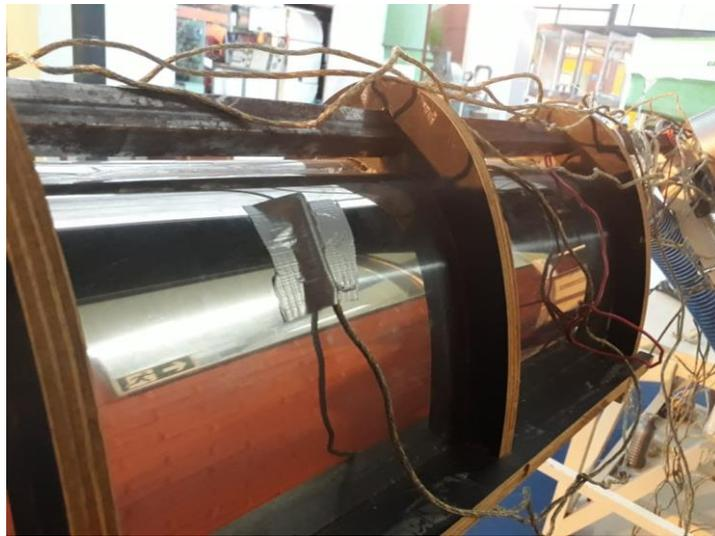
*Figura 65 - Termopar posicionado em superfície*
