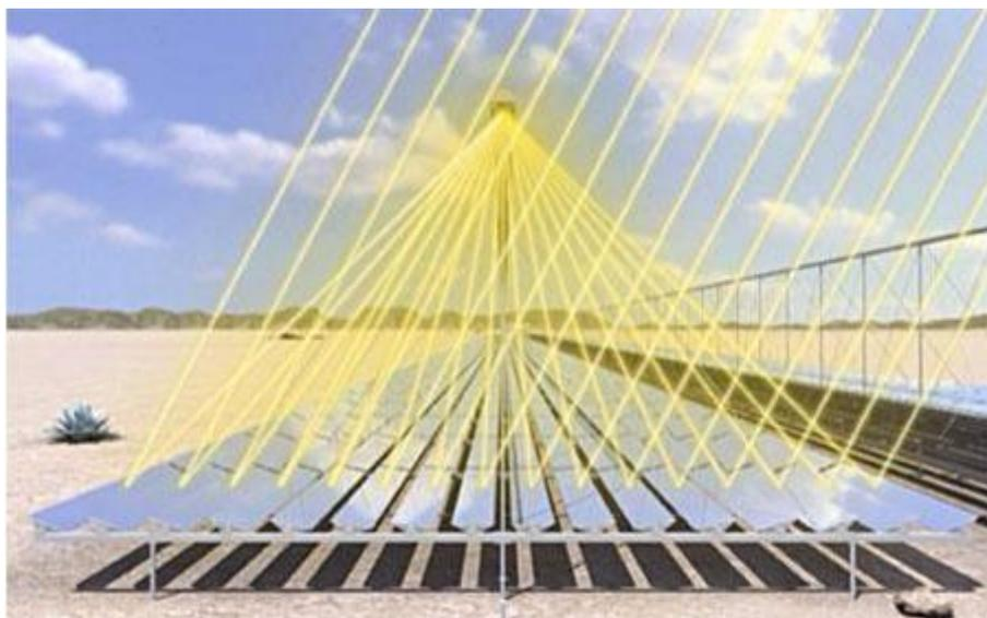
*Figura 10- Exemplo de Refletor Primário e sua função*
