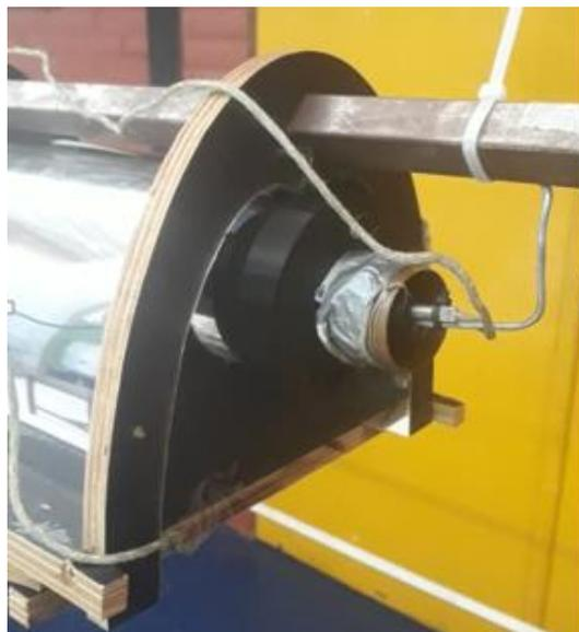
*Figura 64- Fixação do termopar no centro do tubo absorvedor*
