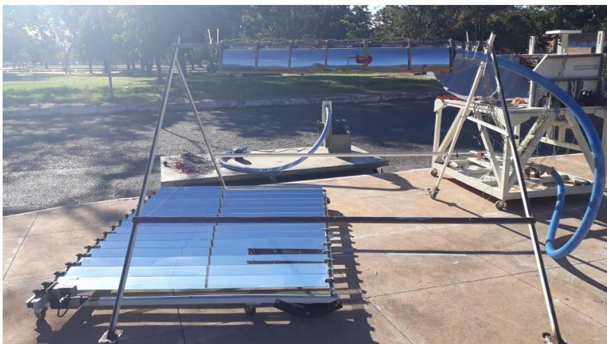
*Figura 59 - Posicionamento lateral para aumentar o fator de interceptação*
