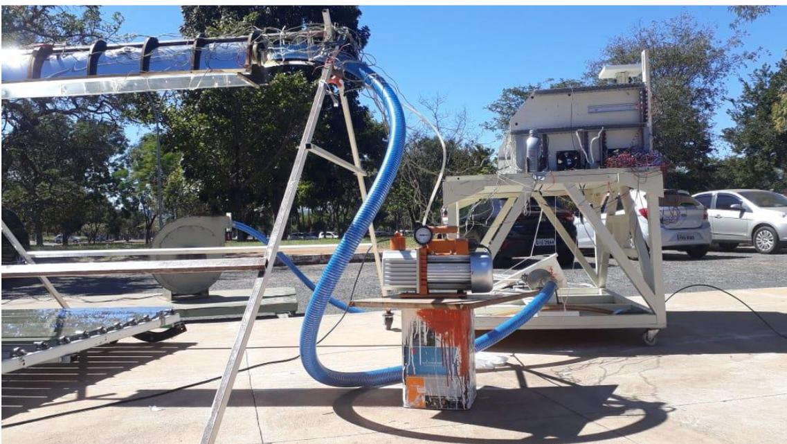
*Figura 62 - Processo de evacuação do tubo absorvedor*
