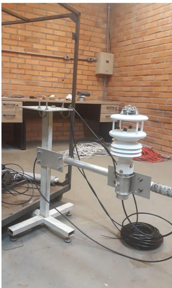
*Figura 54 - Mini estação meteorológica*
