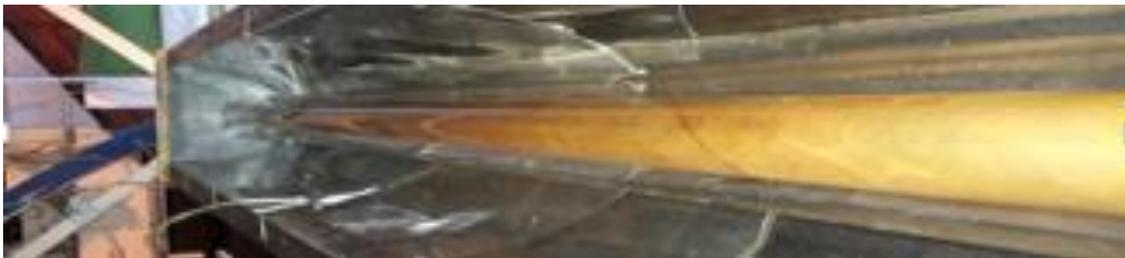
*Figura 44 - Tubo absorvedor evacuado*
