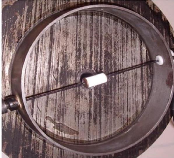
*Figura 10. Absorvedor dinâmico de vibrações (ADV) adaptativo de ligas com memória de forma (Ni-Ti). (Tiseo et al., 2010)*
