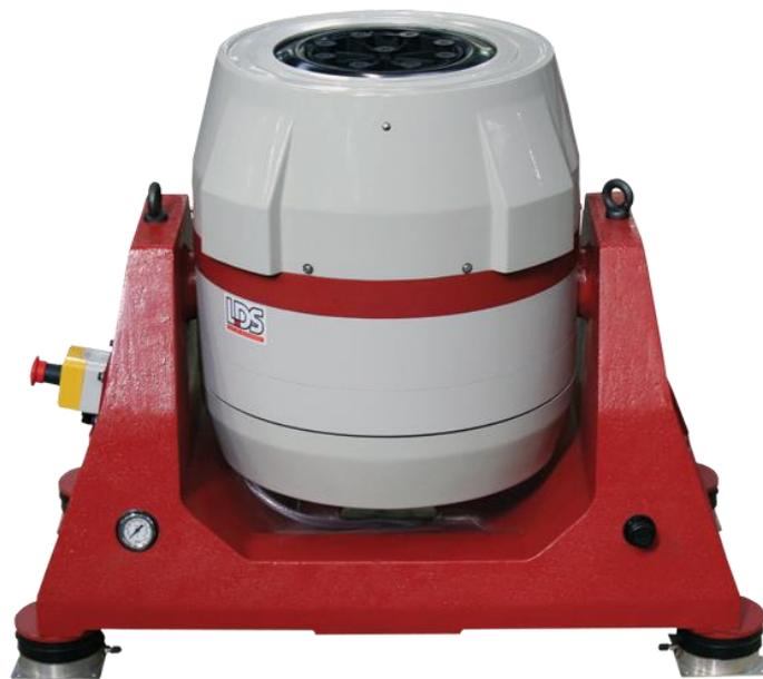
*Figura 17. Shaker LDS V721 utilizado para os ensaios dinâmicos.*
