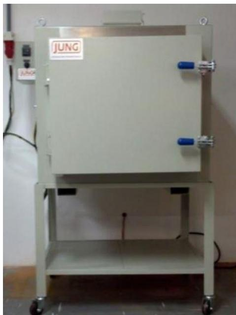
*Figura 12. Forno tipo mufla (Jung FO8080) utilizado para a realização dos tratamentos térmicos.*
