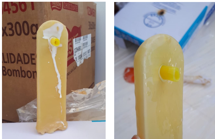
(a) Furo sendo colado na parte da peça. (b) Mangueira colada na parte da peça.
