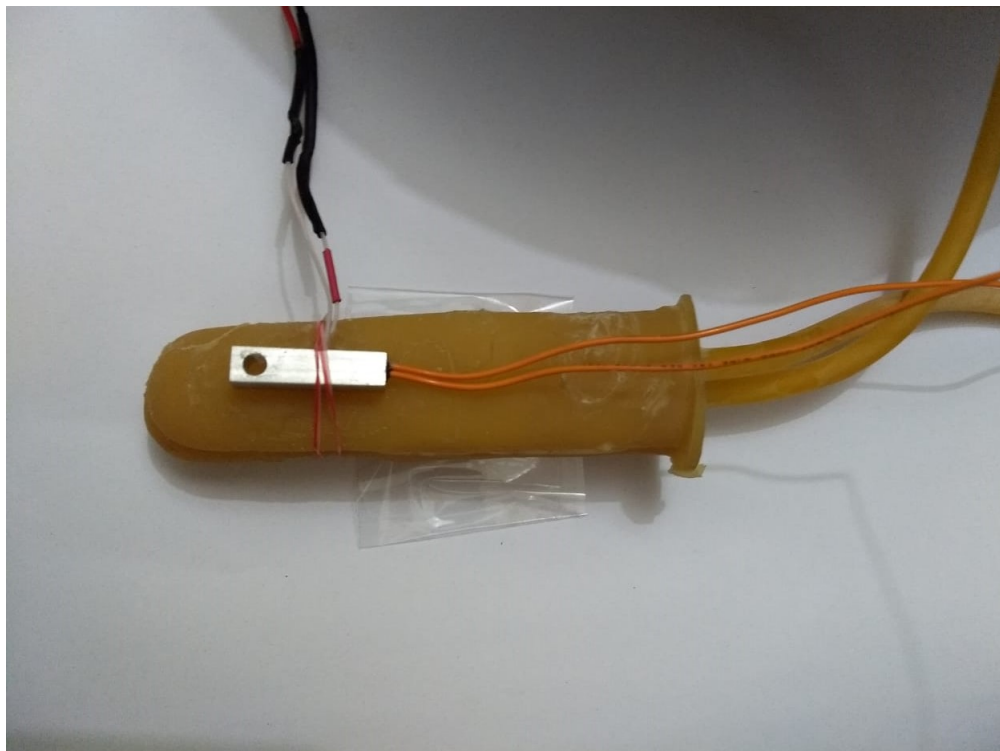
Figura 20 – Termistor de referência em contato com o dispositivo Peltier no cateter.
