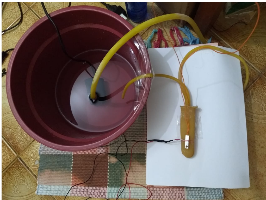
Figura 21 – Cateter conectado à bomba de água pela mangueira de entrada.
