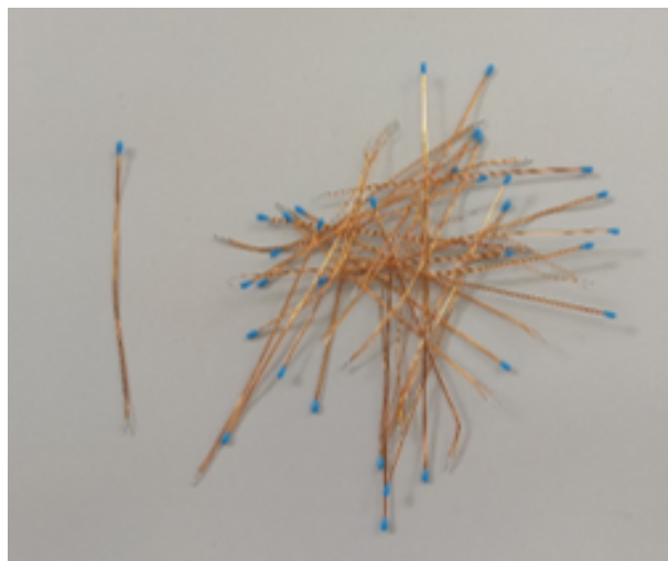
Figura 2 – Termistores escolhidos para desenvolvimento do circuito de aquisição de temperatura. Fonte: (FARIA, 2018).
