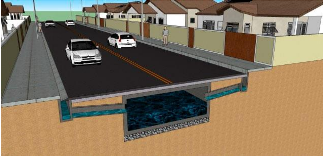
Figura 2.18: Sistema de drenagem incluindo sarjetas e bueiro
