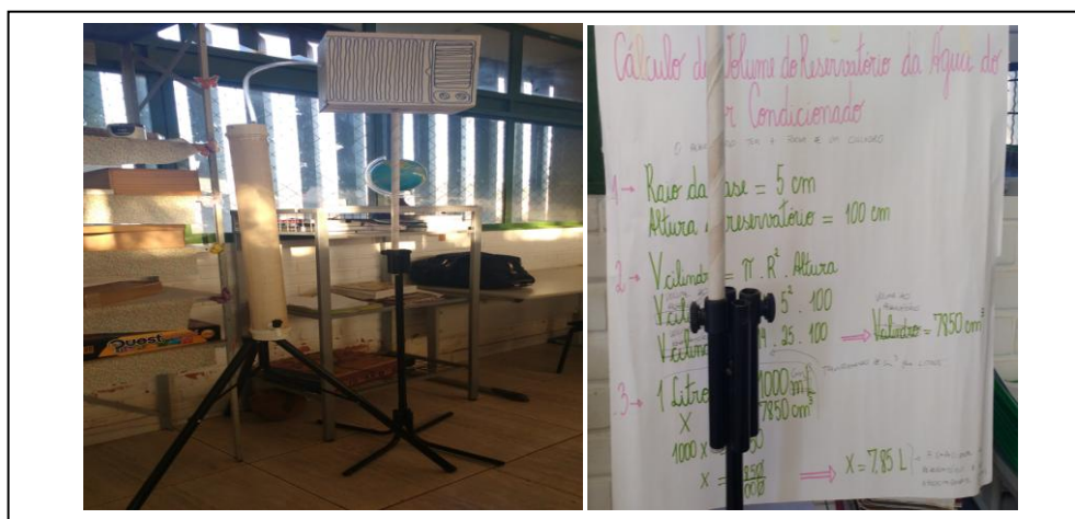
Figura 8 - Material Concreto – Coleta de água do condicionador de ar
