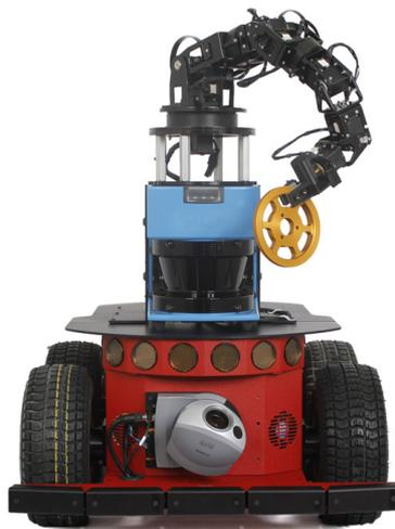
Figura 2.10: Robô Pioneer equipado com anel de sonares, sensor a laser, uma câmera e um braço manipulador. Fonte: <https://robots.ieee.org/robots/pioneer/>
