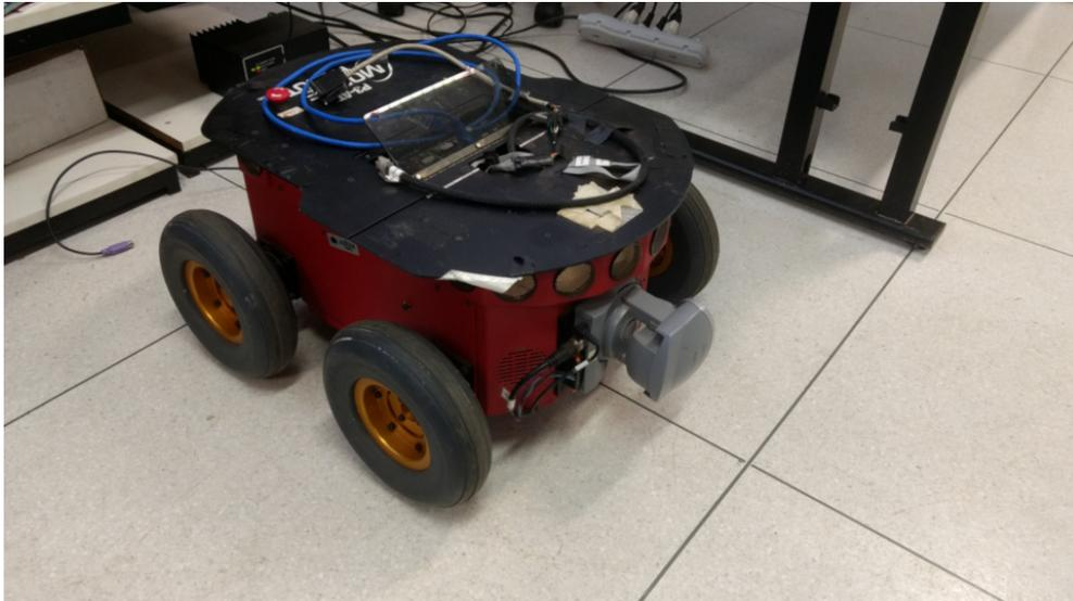
Figura 3.1: Robô Pioneer 3-AT, usado neste trabalho. Fonte: o autor.
