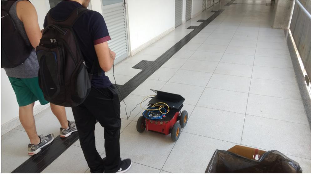
Figura 3.15: Pessoa testando os algoritmos de correção no prédio. O robô está sendo conduzido com o controle, conforme descrito anteriormente, Fonte: o autor.
