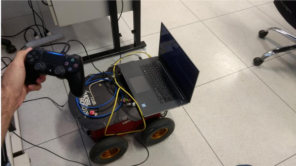
Figura 3.6: Pioneer com notebook e controle conectados. O controle está conectado ao notebook por um cabo USB, e o notebook conectado ao Pioneer por um cabo de rede. Fonte: o autor.
