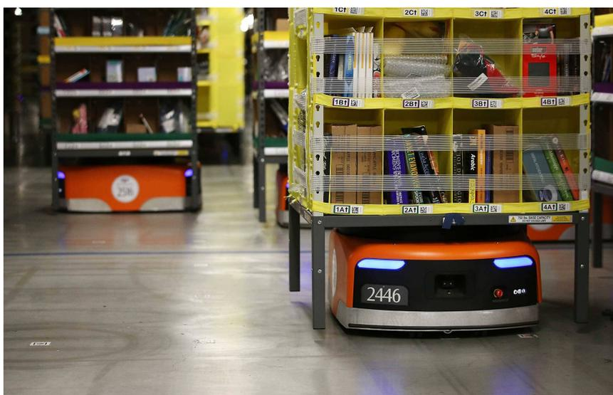
Figura 2.1: Robô móvel usado em armazéns da Amazon. Fonte: [1]
