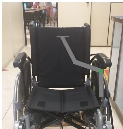
Figura 3.5.2.1 – Representação do suporte para o joystick de queixo
