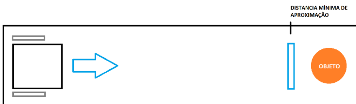
Figura 5.2.1 _ Representação do teste de aproximação
