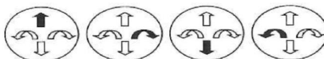
Figura 2.2.5 – Indicação de função no display: seguir em frente, girar à direita, ré e girar a esquerda. [14]
