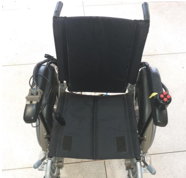
Figura 4.2.2 _ Cadeira com joystick e botões implementados
