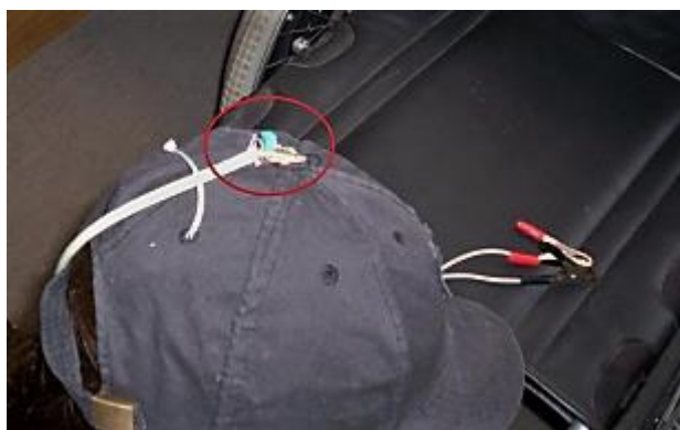
Figura 2.3.1 – Boné com acelerômetro fixado [16]
