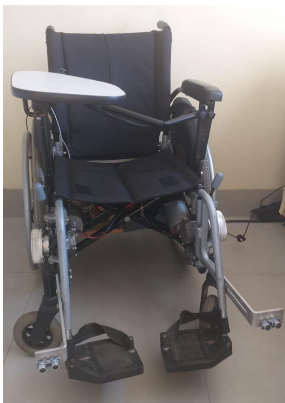
Figura 4.4.3 _ Sensores ultrassônicos instalados
