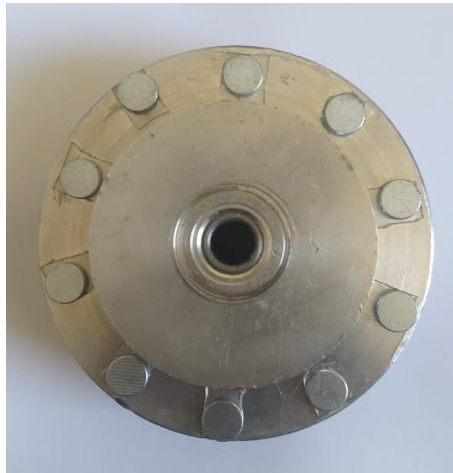
Figura 4.4.1 _ Polia do motor com ímãs
