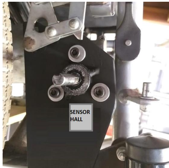
Figura 3.5.3.3 _ Posicionamento do sensor Hall
