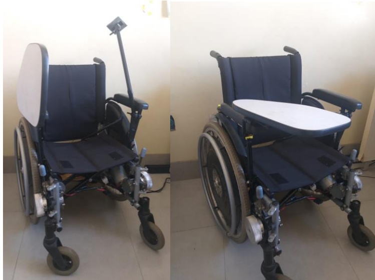
Figura 4.3.2 _ Mesa suporte para notebook instalada.
