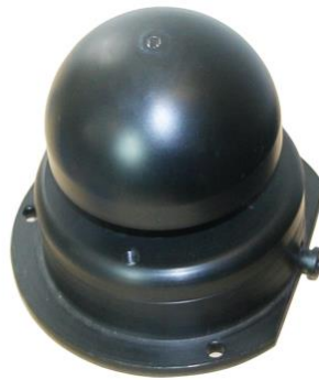
Figura 2.1.4 – Joystick para dedos dos pés [11]
