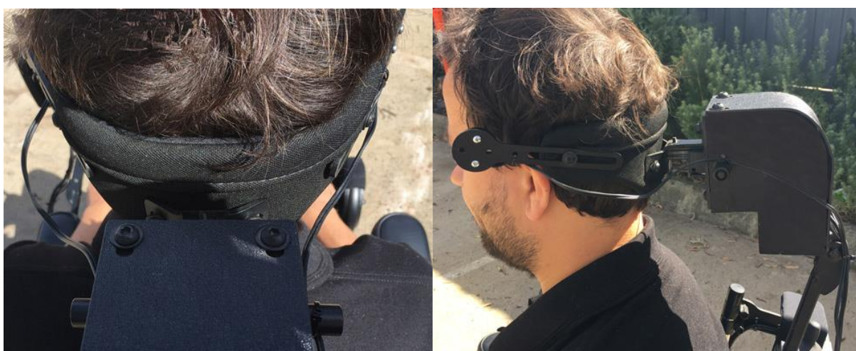
Figura 2.3.2 – Interface de comando fixada no encosto de cabeça.[17]
