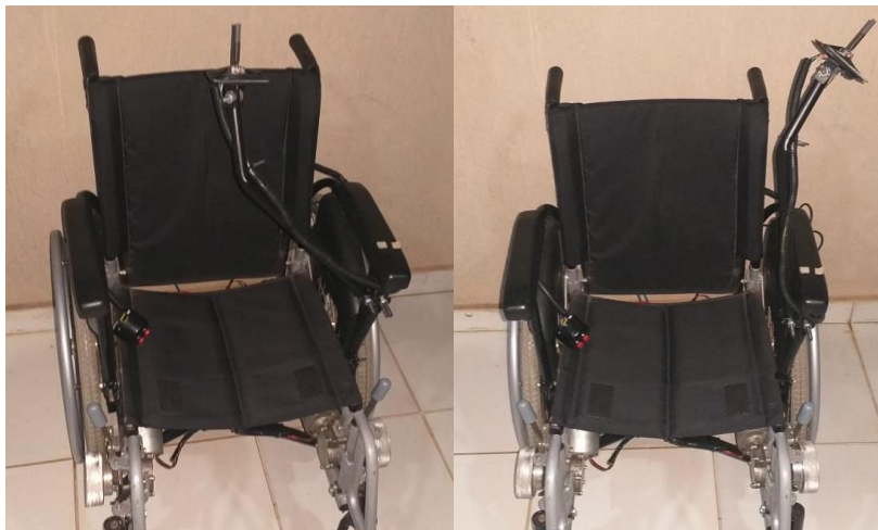
Figura 4.3.1 _ Cadeira com joystick de queixo
