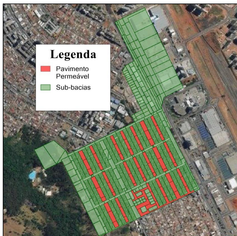
Figura 5.9: Localização dos pavimentos permeáveis
