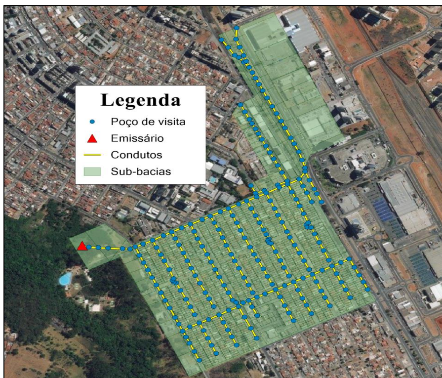
Figura 5.3: Representação conceitual da drenagem
