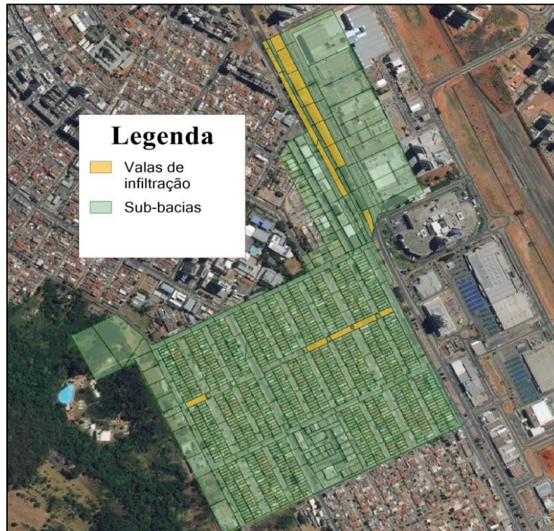
Figura 5.11: Localização das valas de infiltração
