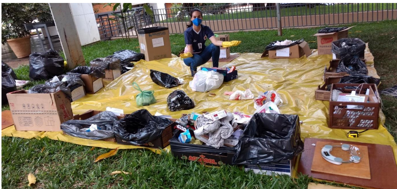
Figura 4.3 – Foto demonstrativa de como foi realizada a análise gravimétrica.
