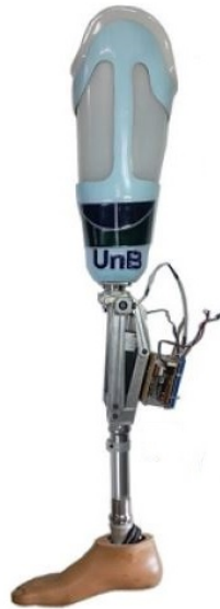
Figura 3.2: Sistema RLEG com circuito embarcado acoplado. Fonte: Adaptado de [Rocha, 2015].
