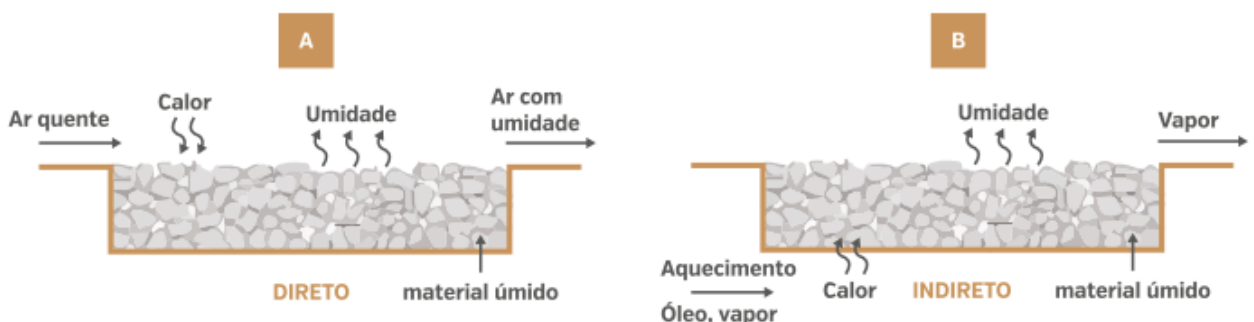
Figura 3.4.6 Esquema da transferência de calor de (a) secadores diretos e (b)secadores indiretos Fonte: Lobato (2011)
