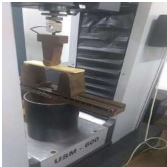
Figura 12 - Máquina de ensaios do LPF durante o teste mecânico de flexão estática.
