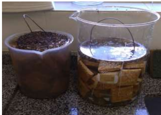
Figura 11 - Recipientes com corpos de prova imersos em água durante os ensaios de inchamento em espessura e absorção de água.
