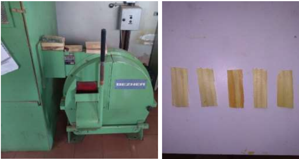
Figura 5 - Equipamento BEZNER com lâminas faqueadoras (esquerda) e flakes produzidos na máquina (direita).
