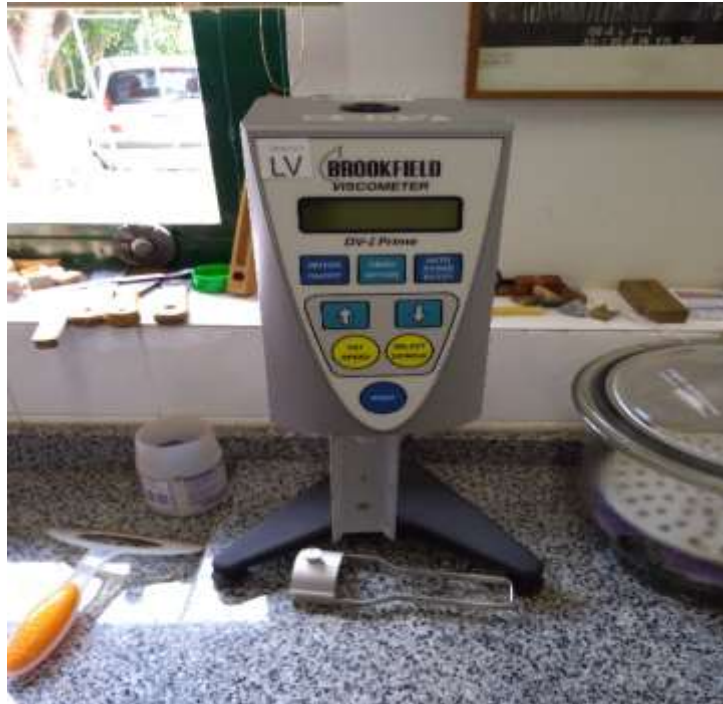
Figura 4 - Aparelho viscosímetro Brookfield LVDV-I Prime utilizado na análise da viscosidade e tempo de gelatinização.
