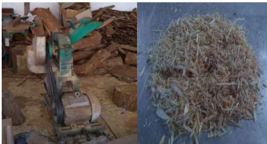
Figura 6 - Moinho de martelo presente na carpintaria do LPF (esquerda) e partículas produzidas no equipamento (direita).
