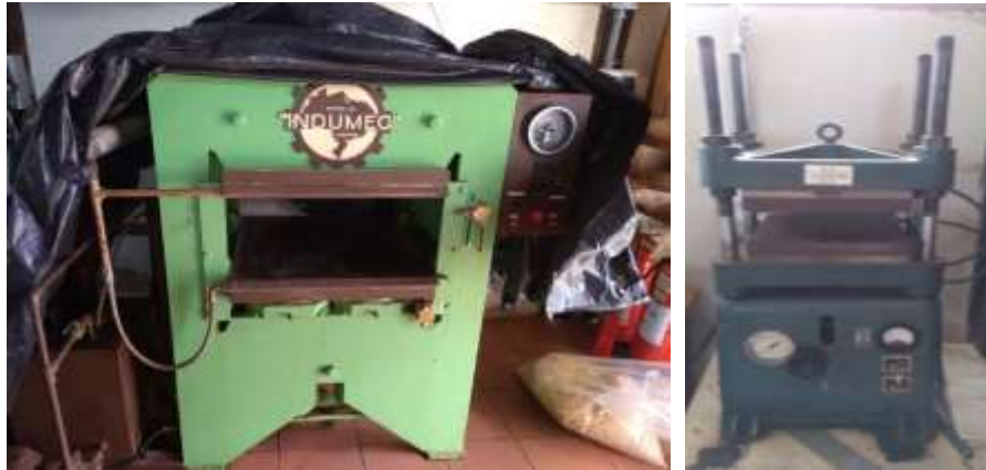
Figura 8 - Prensa hidráulica INDUMEC (esquerda) e prensa hidráulica Wabash (direita) utilizadas nas prensagens à frio e à quente, respectivamente.
