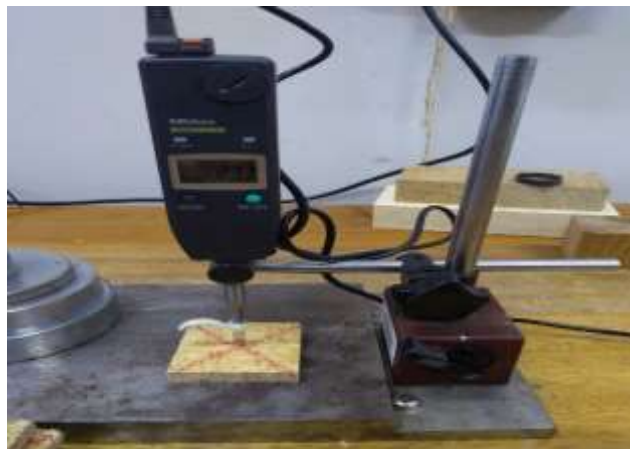
Figura 10 - Relógio comparador utilizado na medição das espessuras dos corpos de prova.
