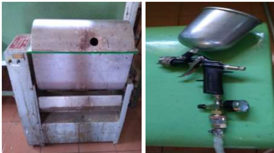
Figura 7 - Misturador de alumínio presente no galpão de engenharia do LPF (esquerda) e pistola de ar comprimido com regulador de pressão (direita).
