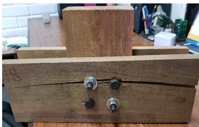
Figura 11 - Falha por fendilhamento observada em todos os CPs de ipê.
