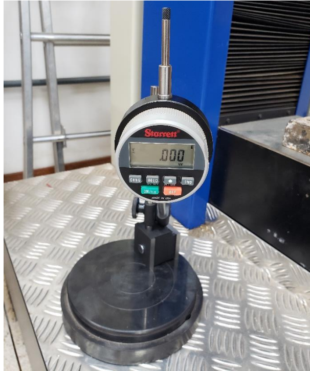
Figura 6 - Relógio transdutor de deslocamento Starrett®.
