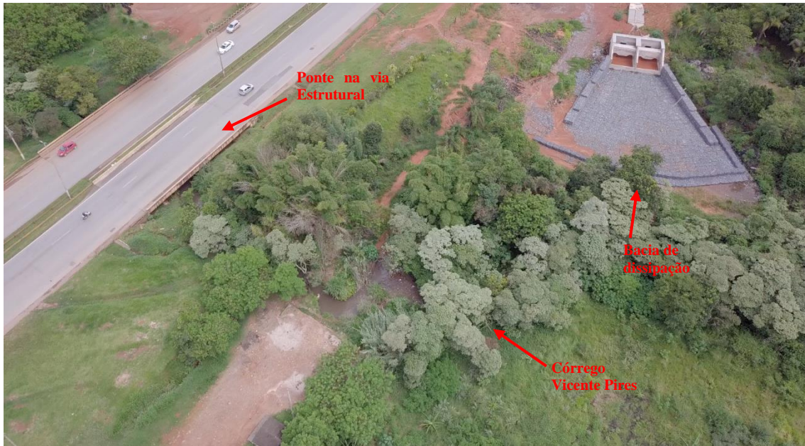
Figura 4.11 - Bacia de dissipação ao final da rede.
