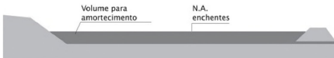
Figura 3.13 - Esquema de bacia de retenção (CANHOLI, 2014).
