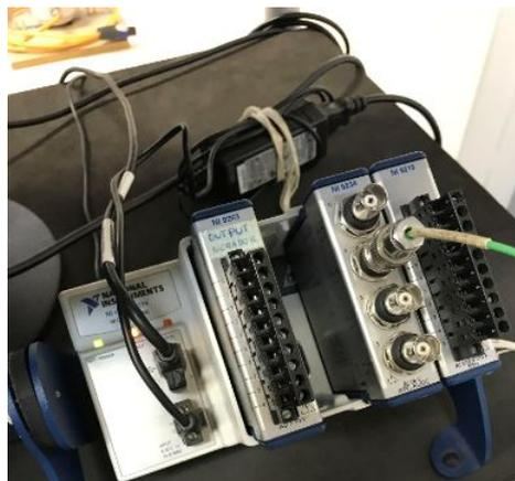
Figura 12: Representação das conexões na placa de aquisição e no módulo NI 9234.
