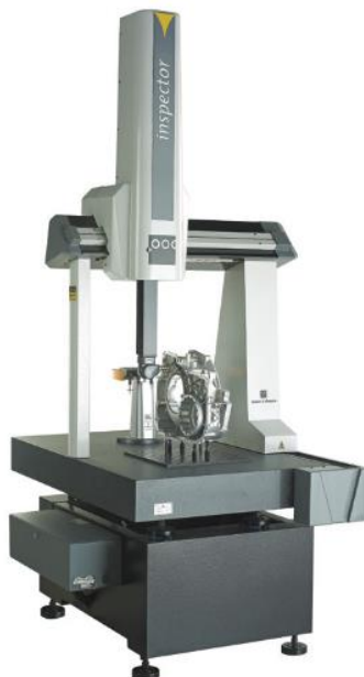
Figura 2.3: MMC do tipo ponte móvel Fonte: Brown & Sharpe (2014)
