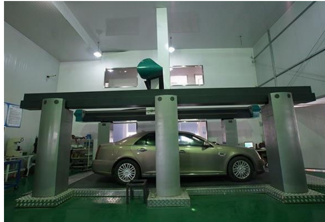
Figura 2.8 Inspeção de veículo utilizando MMC do tipo pórtico série summary Fonte: Nano Metrology (2016)
