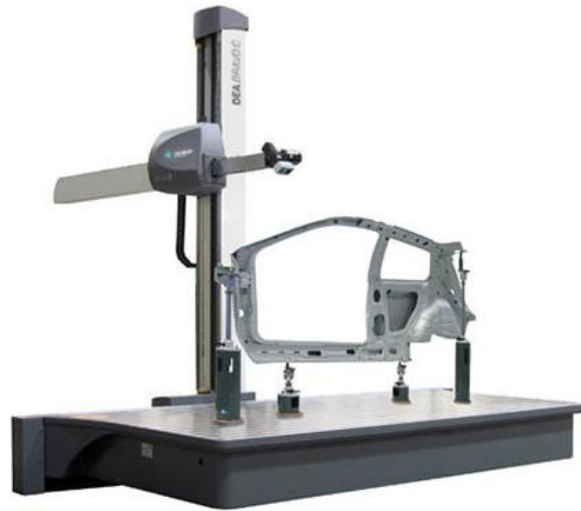
Figura 2.6 MMC do tipo braço horizontal Fonte: Hexagon (2016)
