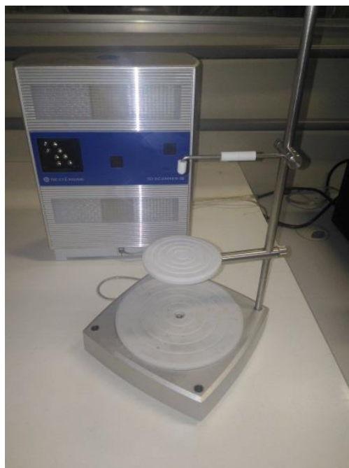
Figura 2.10: Scanner 3D NextEngine do laboratório de Metrologia UnB
