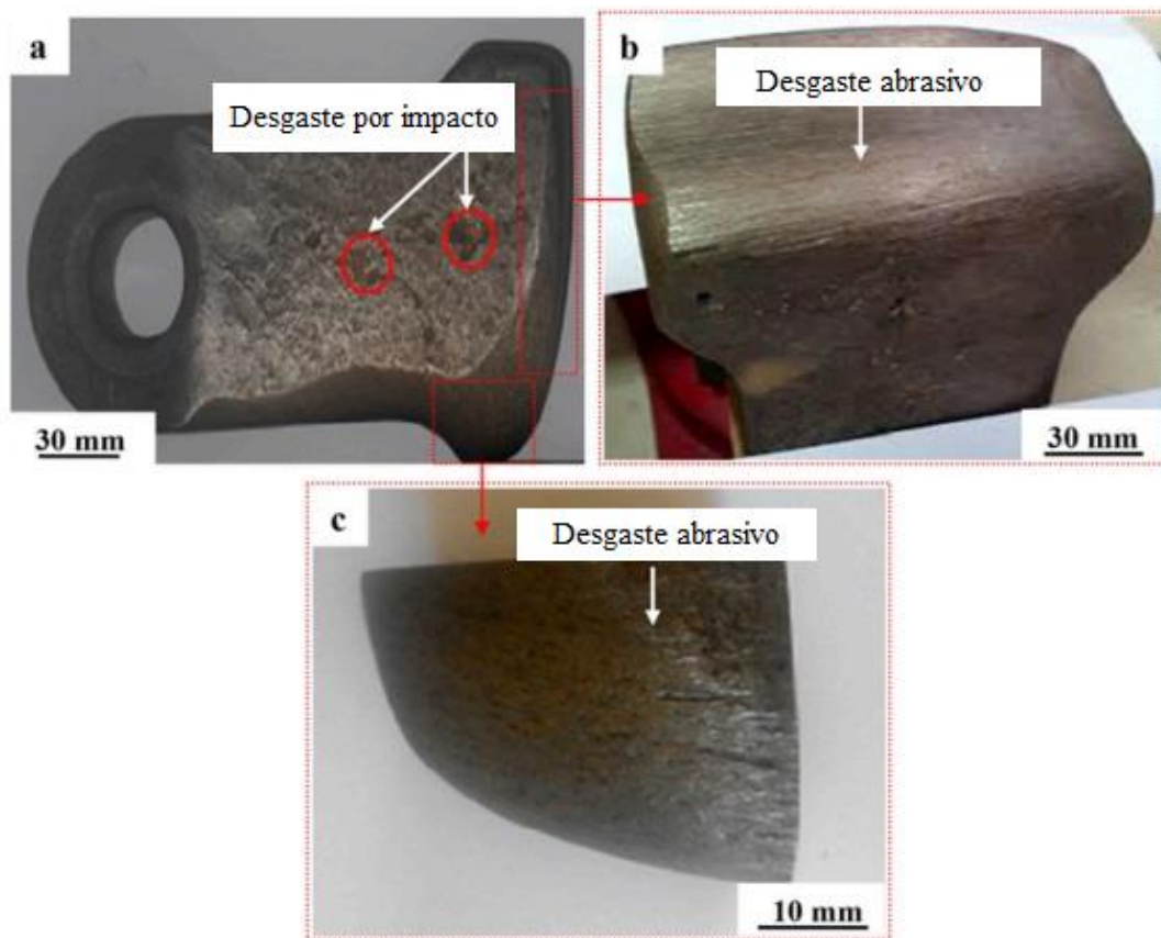
Figura 25. Martelo vista superfície danificada: (a) superfície lateral, (b) superfície superior e (c) a superfície de canto. (KALLEL, ZOUCHE, ANTAR, BAHRI, ELLEUCH, 2017).
