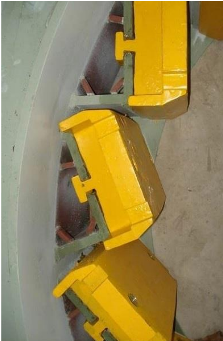
Figura 31. Vista lateral de bigornas fixas montadas em um mostruário (KALLEL, ZOUCHE, ANTAR, BAHRI, ELLEUCH, 2017)
