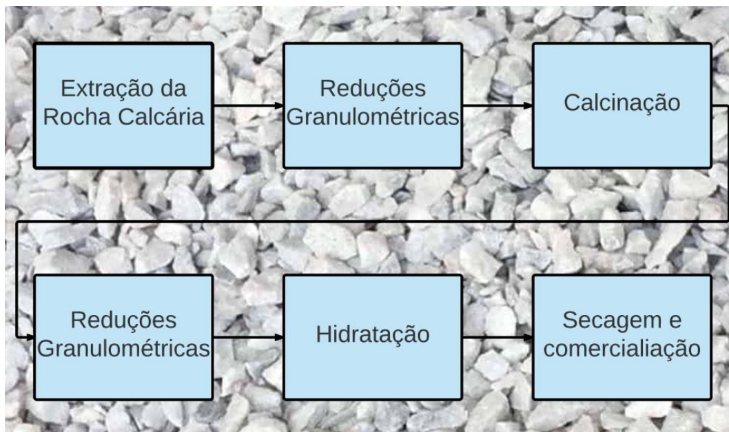
Figura 9. Fluxograma dos processos de produção do carbonato de cálcio.
