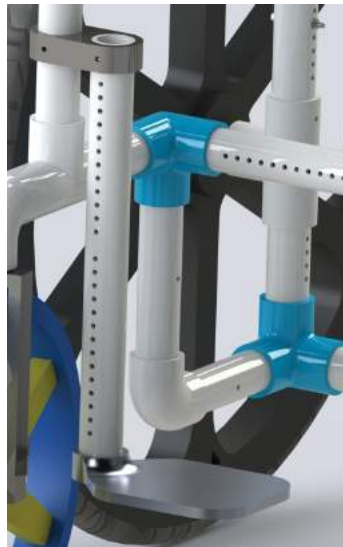
Figura 79 – Detalhes de Encaixe do Apoio de Pé da Cadeira de Rodas Projetada
