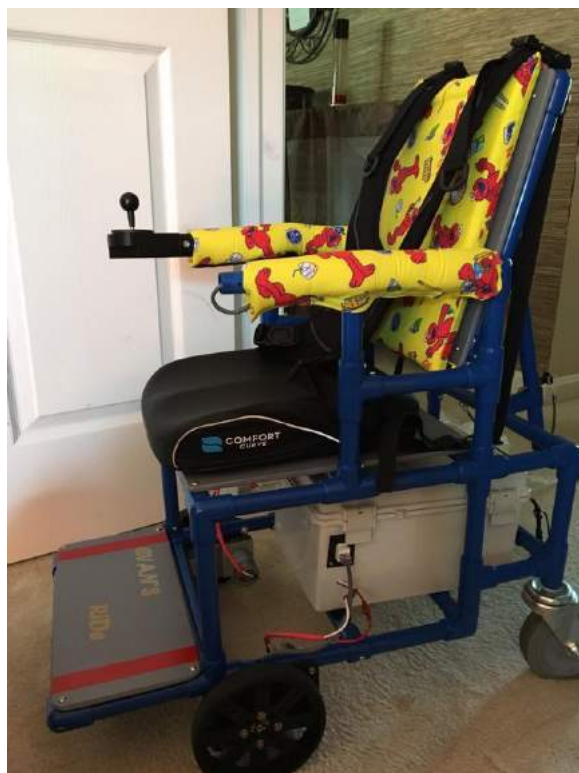
Figura 39 – Cadeira de Rodas Feita em Tubos de PVC (OPEN WHEELCHAIR FOUNDATION, 2017)
