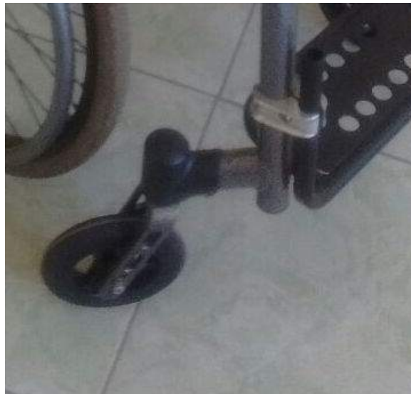
Figura 80 – Detalhe do Encaixe do Apoio de Pé por Meio de Abraçadeiras em Cadeira de Rodas Comercial
