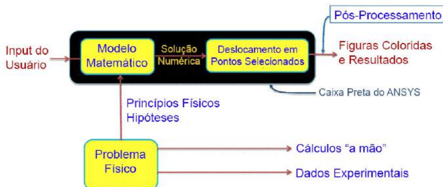
Figura 84 – Modelo de Funcionamento do Método de Elementos Finitos (BHASKARAN, 2018)
