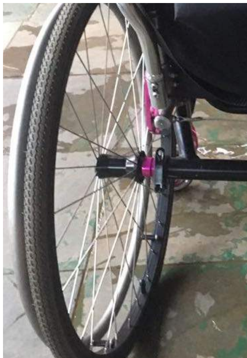
Figura 71 – Detalhe do Encaixe da Roda Traseira na Estrutura
