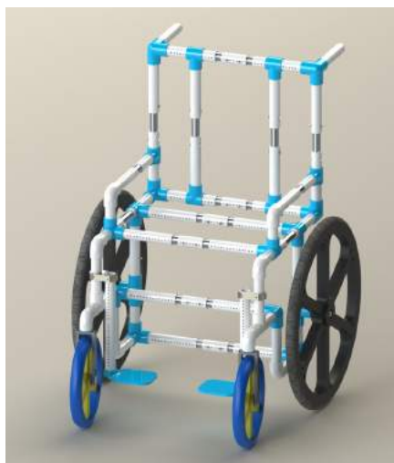
Figura 151 – Estrutura da Cadeira de Rodas com 4 Barras Verticais no Encosto
