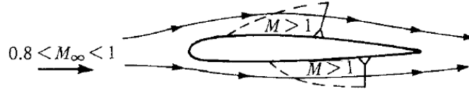
Figura 2.7: Escoamento transônico Fonte: modificado de Anderson (2011).
