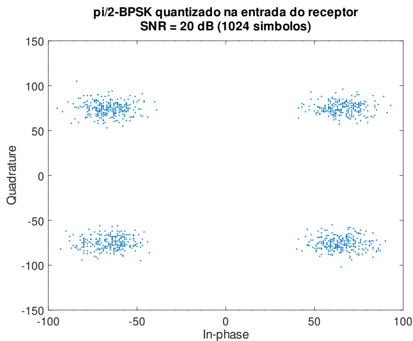
Figura 22 – \pi/2 -BPSK recebido na entrada do receptor
