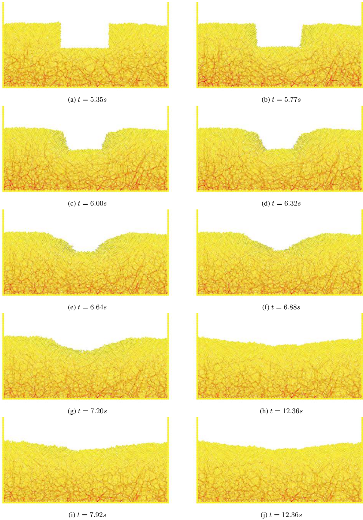
Figura 7.18: Evolução do colapso de uma cratera estreita com H/L = 0.5 . 7284 partículas.
