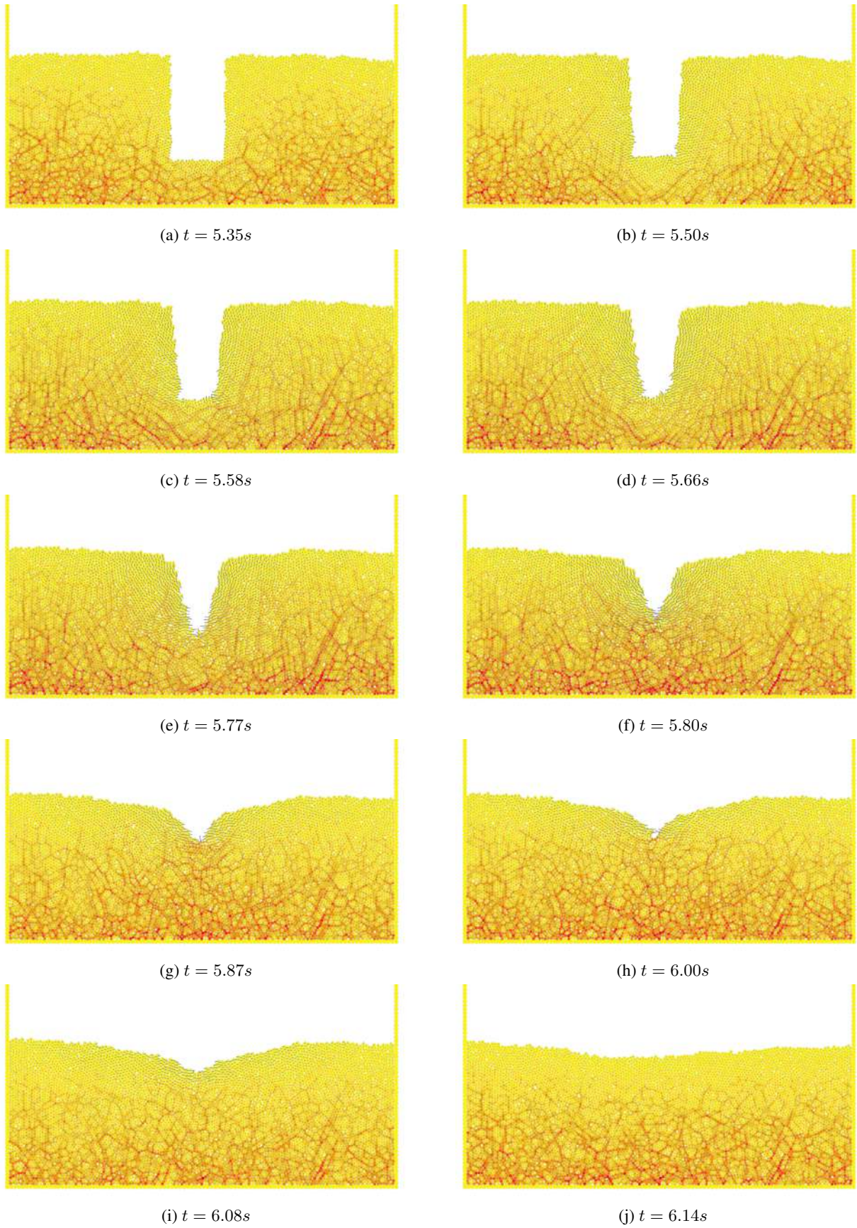
Figura 7.13: Evolução do colapso de uma cratera com H/L = 2.0 . 7284 partículas.
