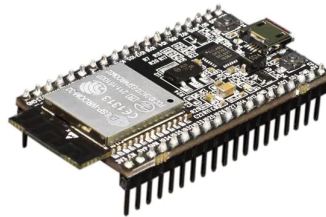
Figura 8 – ESP32 na plataforma DevKitC, utilizado no projeto. Fonte: Mouser (2018)
