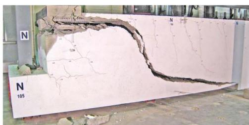
a) modo de ruptura do modelo ensaiado
