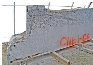
a) degradação do concreto e fissura inclinada acima dos ganchos de ancoragem da armadura de suspensão
