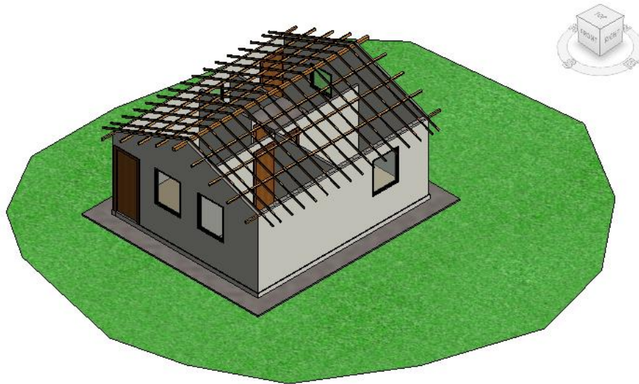
Figura 23: Estrutura de sustentação do telhado
