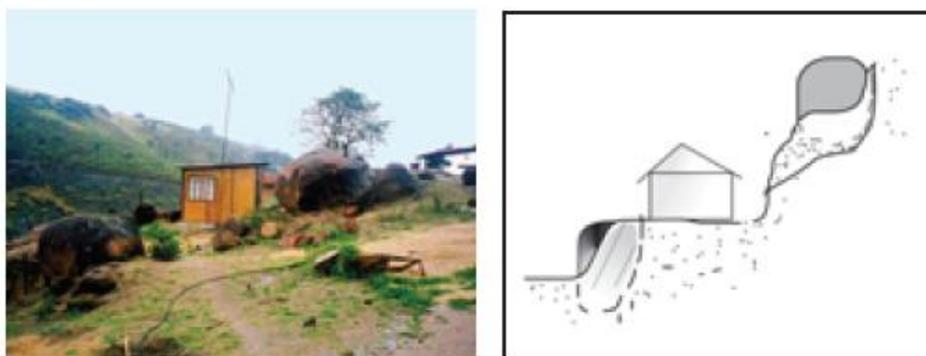
Figura 3.6: Situação de risco de rolamento de bloco rochoso e perfil esquemático de rolamento de bloco rochoso.
