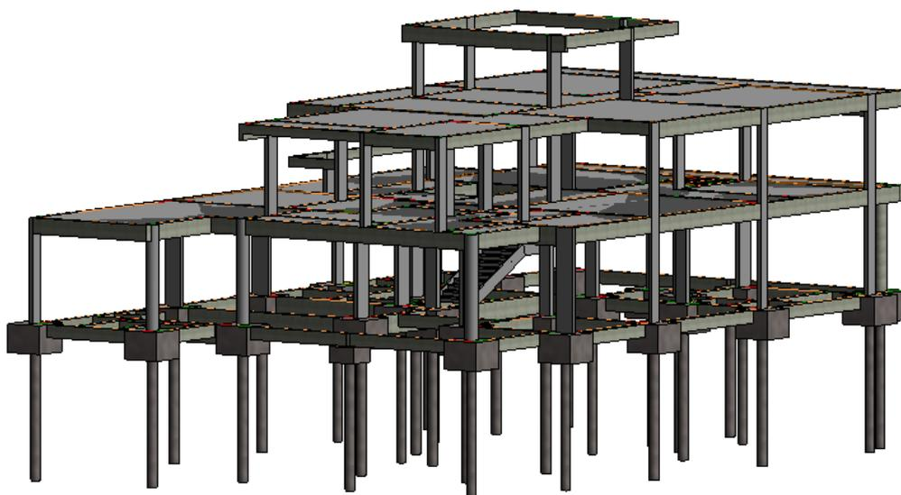
Figura 5-37 - Fundação, Vigas, Pilares e Lajes no Modelo
