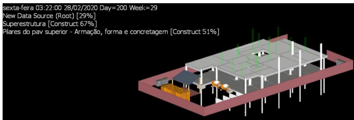
Figura C-2 - Execução da Superestrutura
