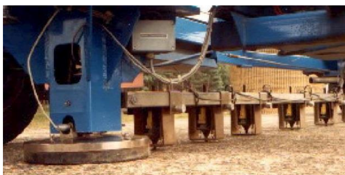
Figura 2. 4– Sensores de medida de deflexão do FWD
