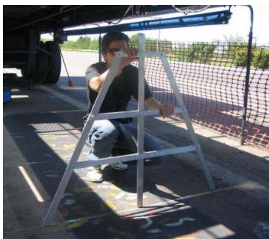
Figura 3.2 - Treliça metálica para a medição dos afundamentos de trilha de roda.
