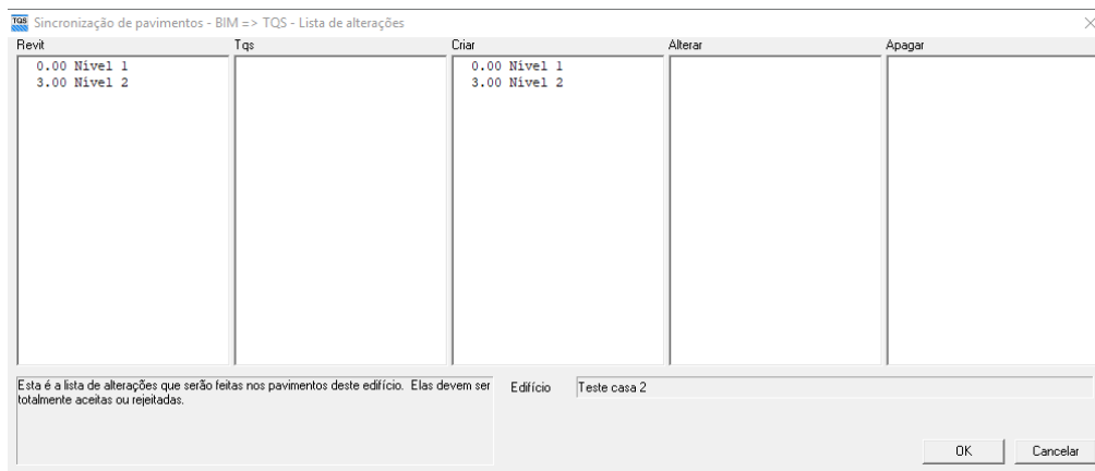
Figura 4.13: Sincronização de pavimentos do Revit para o TQS. Fonte: o autor (2019).
