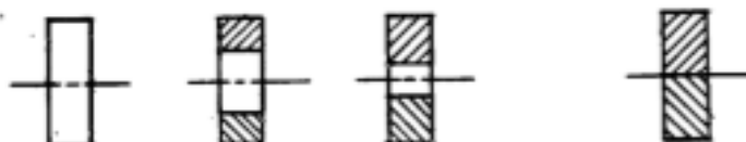
Figura 2.5 – Resultante da distribuição das tensões em uma seção retangular (BEEDLE; KETTER, 1955)
