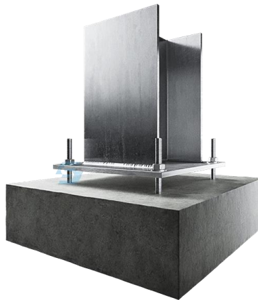
Figura 13.11 – Apoio genérico simplificado de uma estrutura metálica
