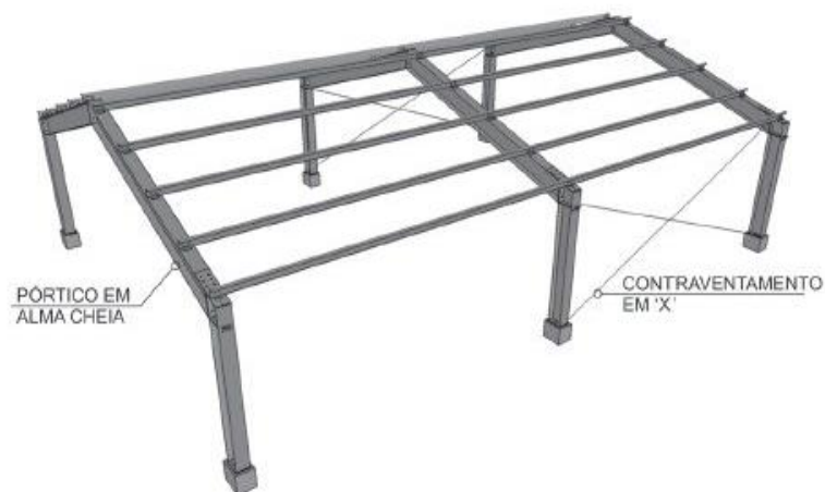
Figura 7.7 – Sistema de contraventamento (Fonte: fullestruturas.com.br/estrutura-metalica-para-galpaio )
