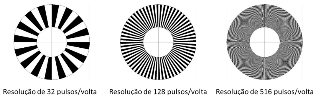
Figura 17 – Discos de Encoder e suas resoluções.
