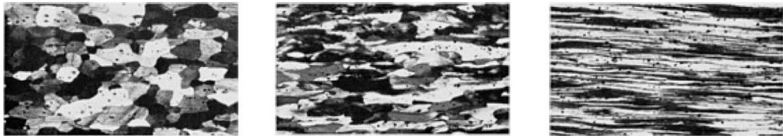
Figura 2-10 Efeito de laminação a frio na liga 5457 recozida, originalmente com 10mm de espessura; a) 10% redução b) 40% de redução c) 80% redução. Reagente Barker. 100X. Fonte: ASM Handbook Vol. 2
