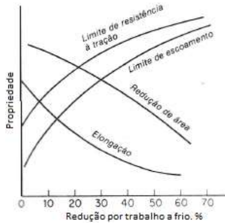
Figura 2-7 Variação das propriedades trativas com a quantidade de trabalho a frio. Fonte: DIETER (1981)
