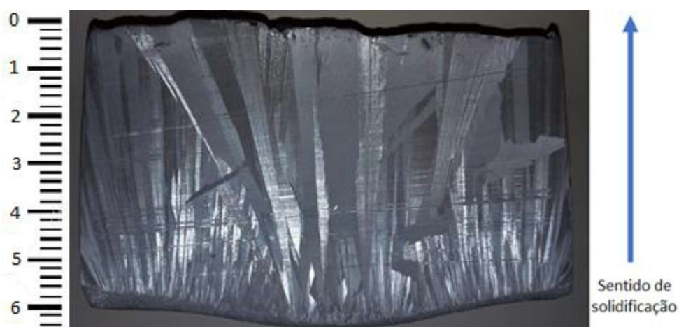
Figura 4-5 Macroestrutura bruta de fusão da liga Al0,4%W fabricada
