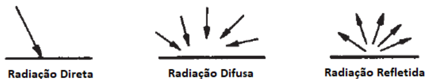
Figura 2.22: Fluxo de energia radiante importante em um processo térmico. (Fonte Duffie e Beckman, Solar Engineering of Thermal Processes 1980)
