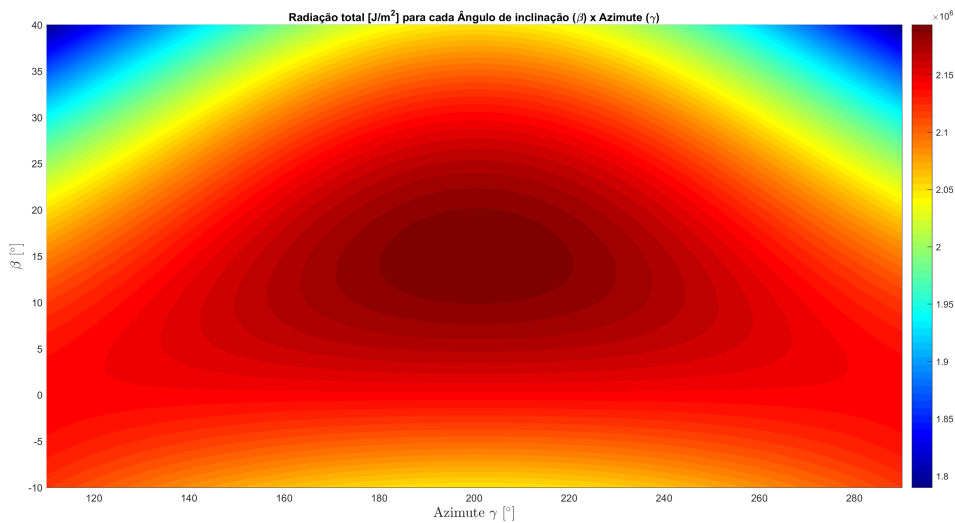
Figura 4.55: Valores do TMY de irradiância na placa para diversos ângulos de orientação em São Paulo-SP \phi = -23,62^\circ .
