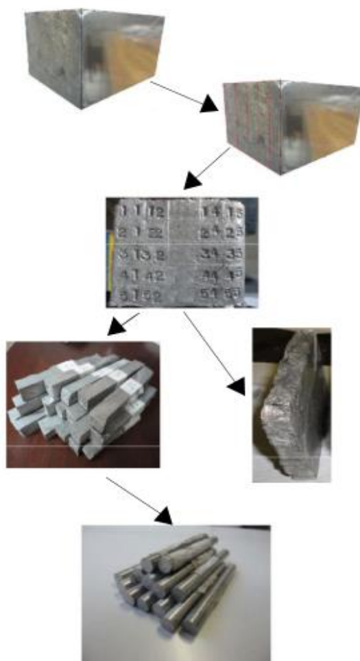
Figura 19. Detalhamento do corte do lingote para obtenção das amostras para laminação adaptado de (SILVA, 2017).
