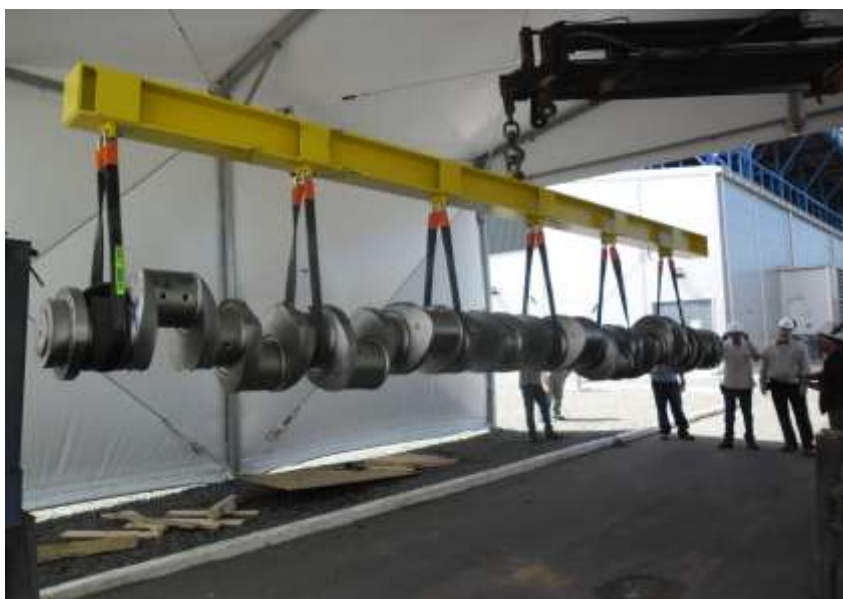
Figura 1.1 – Eixo virabrequim de grupo gerador com aproximadamente 7 metros de comprimento e 6 toneladas.
