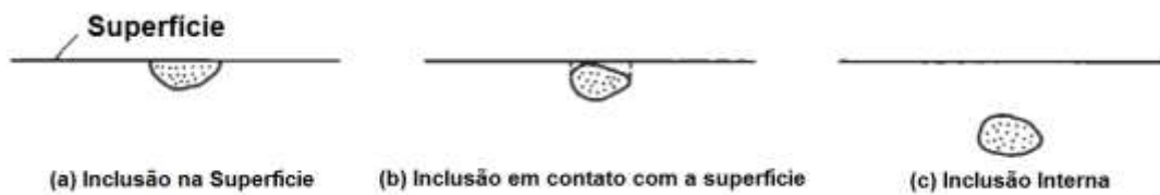
Figura 3.2 – Classificação das inclusões por localização. (Murakami, 2002).
