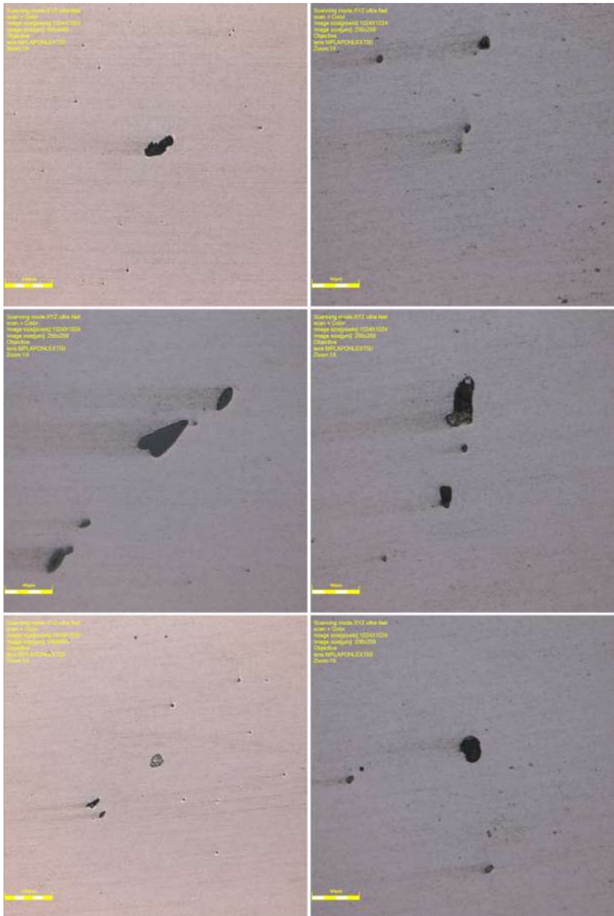
Figura 7.9 – Inclusões no plano de tensão principal torcional, para uma amostra não falhada.
