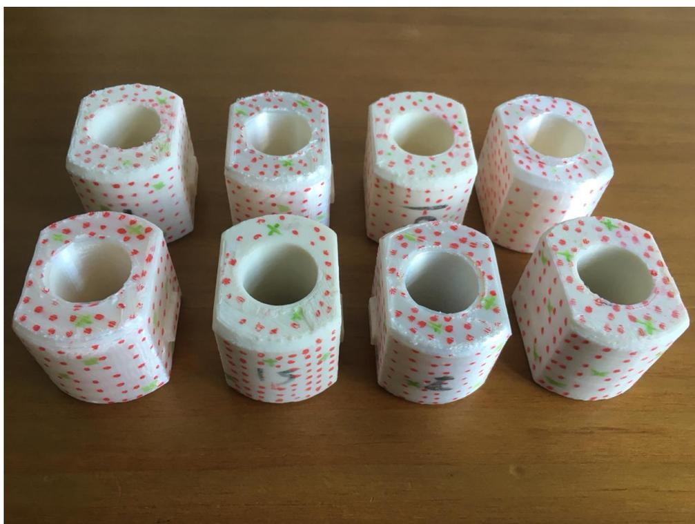
**Figura 4.5: Defeito superficial nas bordas das peças impressas na direção z (peças 1, 4, 6, 7, 9, 10, 11 e 15)**
