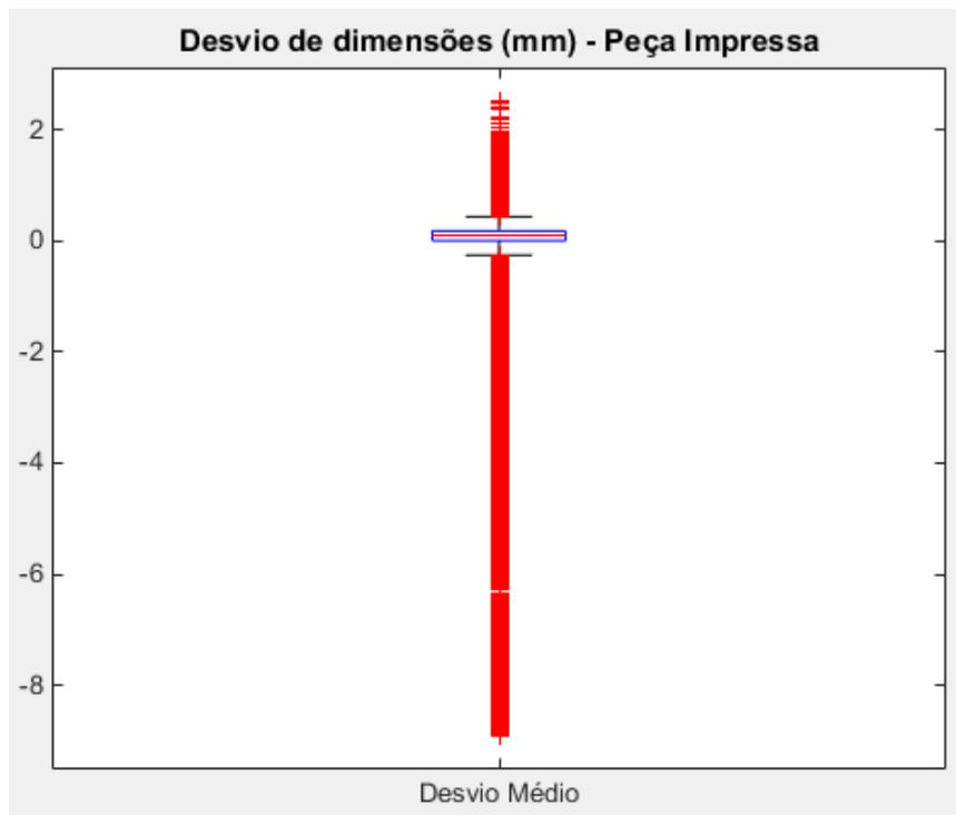
**Figura 3.5: Gráfico boxplot mostrando o limite adjacente superior para a peça impressa**
