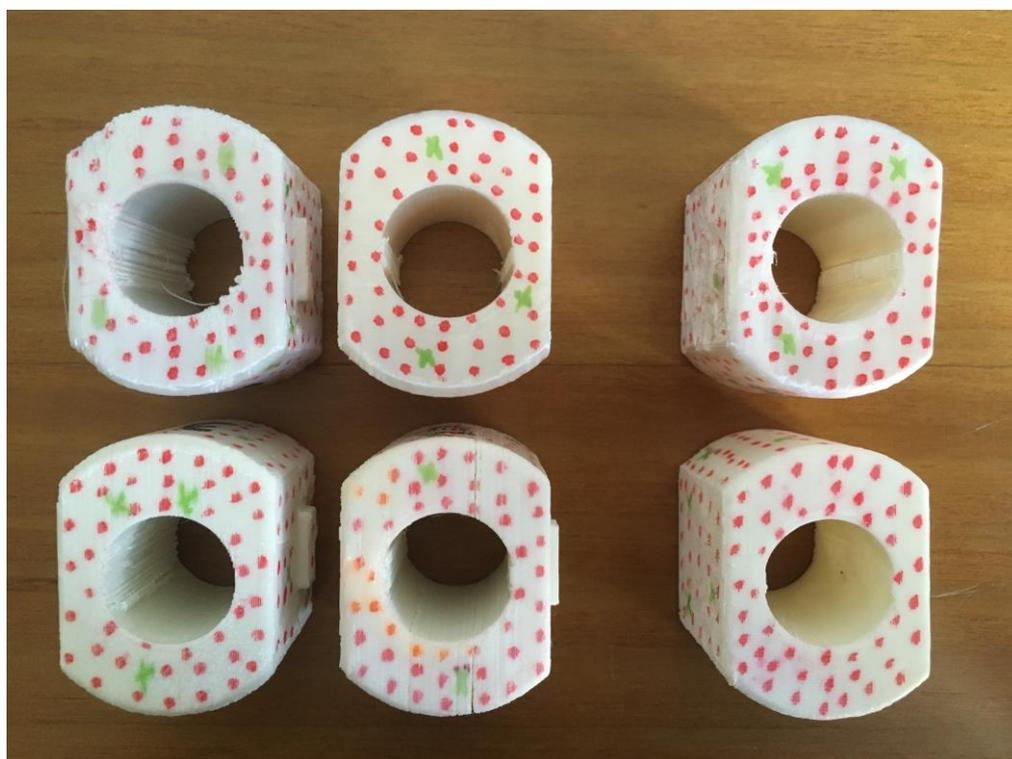
**Figura 4.3: Peças que ficaram com resquícios de suporte (à esquerda, peças com preenchimento de 90% e à direita, peças com preenchimento de 10%)**
