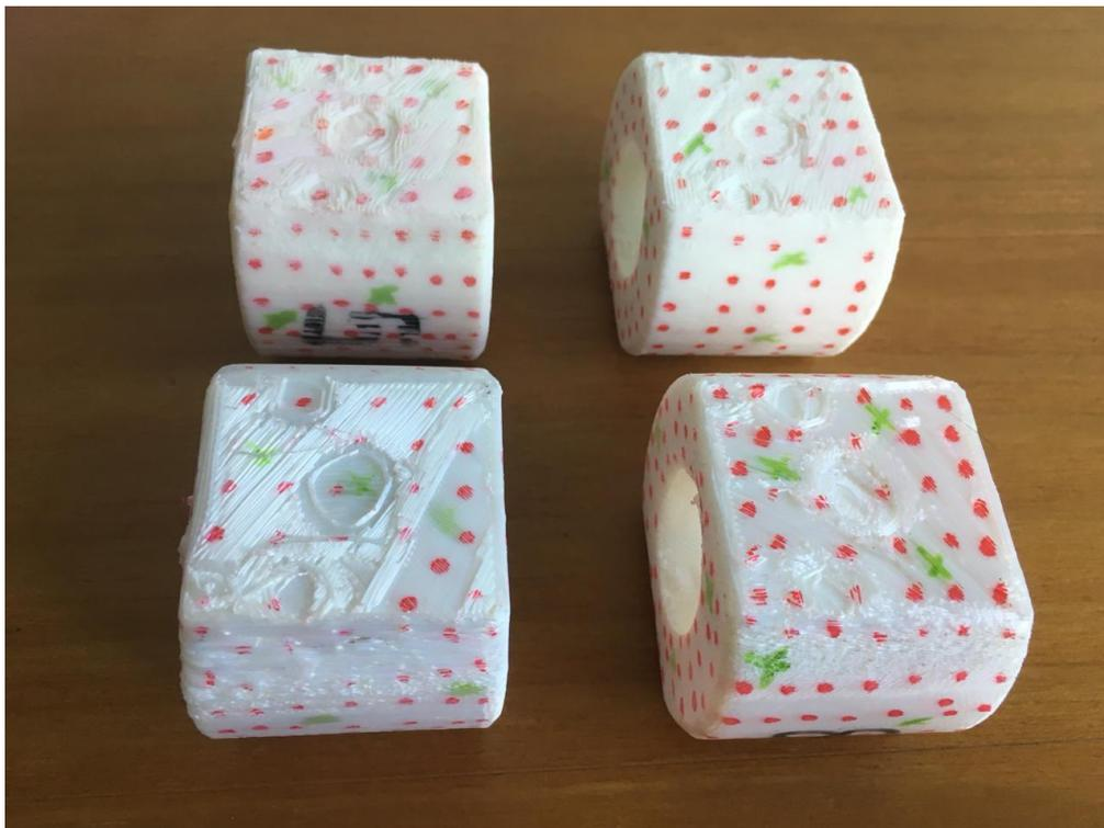
**Figura 4.6: Defeito superficial nas bordas das peças impressas na direção x (peças 3, 5, 8, 14)**
