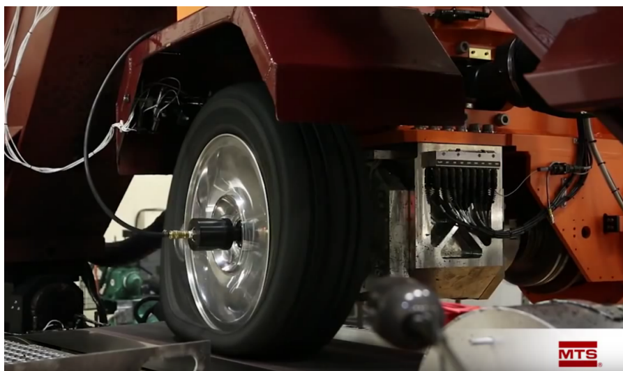
Figura 36: Pneu sendo testado com \alpha > 0 e \kappa = 0 .(CORPORATION, 2013)
