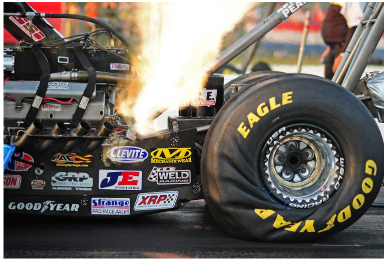
Figura 34: Deformação de pneu com \alpha = 0 e \kappa > 0 . (U/KIYIKO, 2013)
