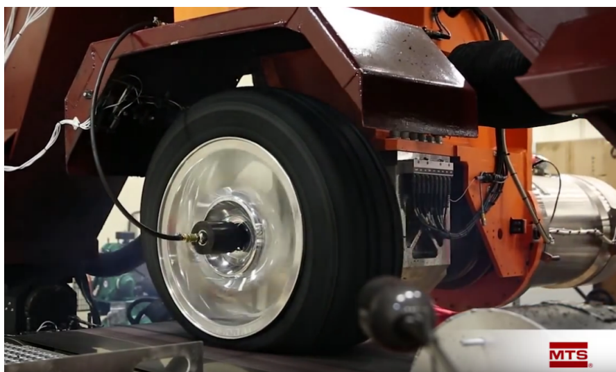
Figura 37: Pneu sendo testado com \alpha < 0 e \kappa = 0 . (CORPORATION, 2013)
