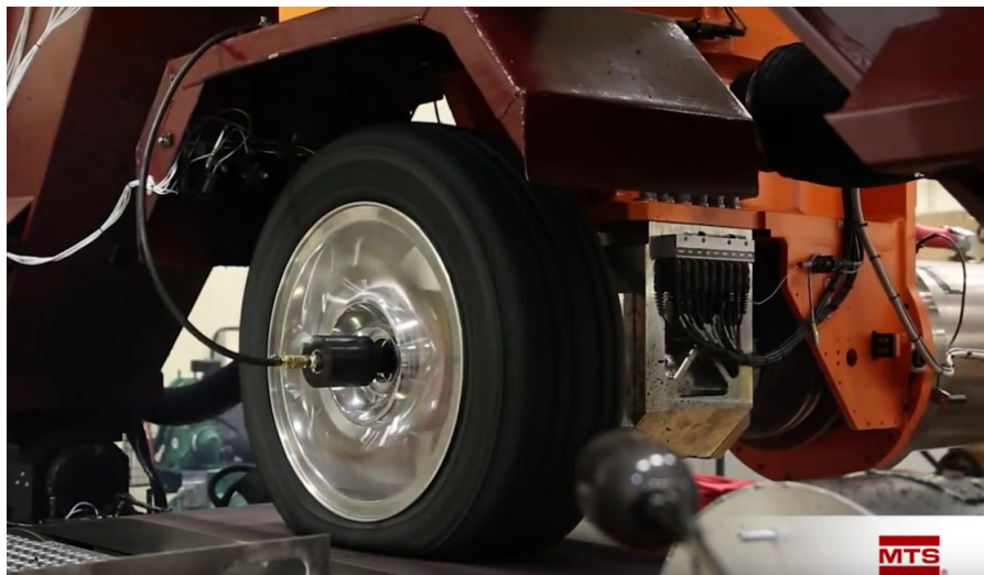
Figura 35: Pneu sendo Testado com \alpha = \kappa = 0 . (CORPORATION, 2013)
