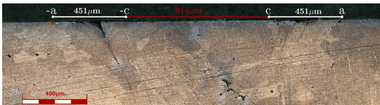
Figura 33 – Contato com trincas da Configuração 7 Ensaio 1.
