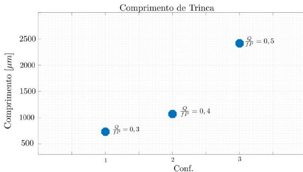
Figura 36 – Variação do comprimento de trinca com aumento da carga cisalhante.
