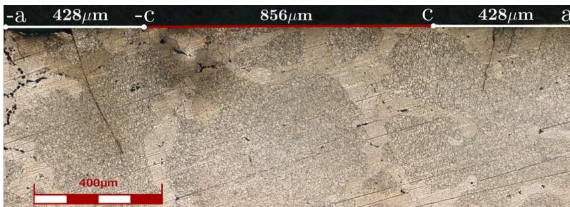
Figura 32 – Contato com trincas da Configuração 8 Ensaio 2.
