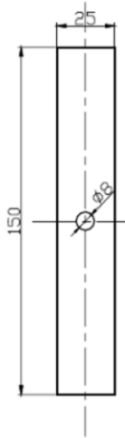
Figura 18 – Desenho do CP com furo \phi 8\text{mm} (SUSMEL; TAYLOR, 2007)
