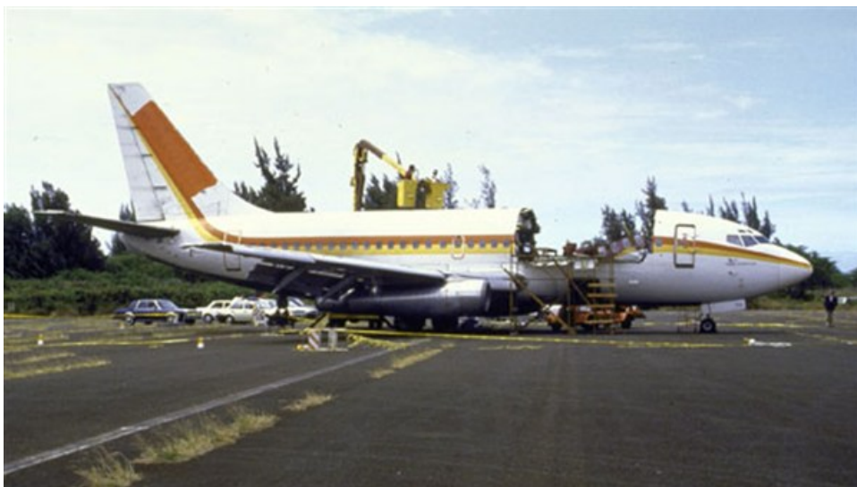
Figura 2 – Acidente causado por fadiga - voo 243 da Aloha Airlines.
