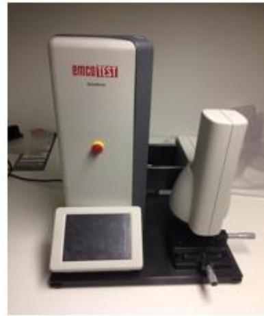
Figura 26. Sentido de endentação (a) e Microdurômetro (b).
