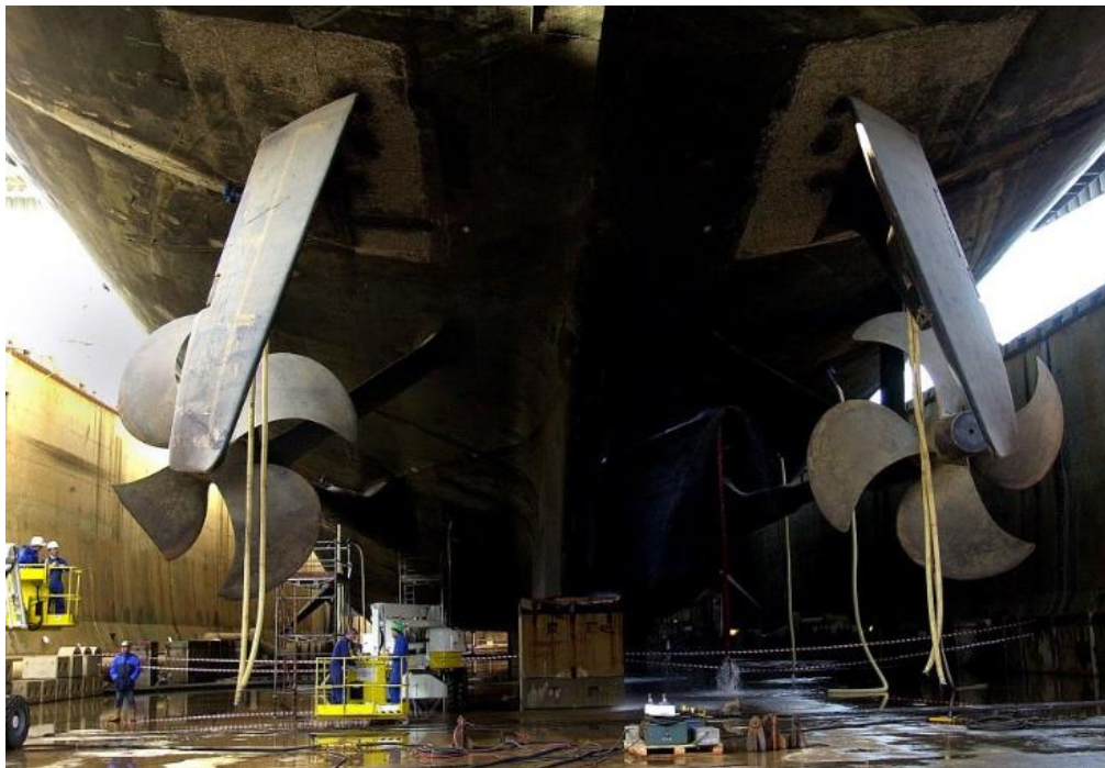
Figura 1.3: Navio Charles de Gaulle ancorado em Toulon com uma de suas hélices quebrada. (Fonte: Philippe Laurenson / Reuters 12/08/2000)
