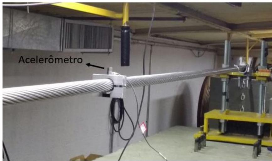
Figura 4.16 – Acelerômetro localizado no primeiro anti-nó
