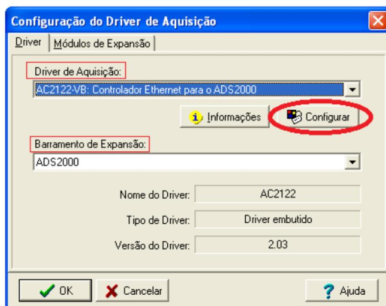
Figura B.2 – Janela de configuração do driver de aquisição
