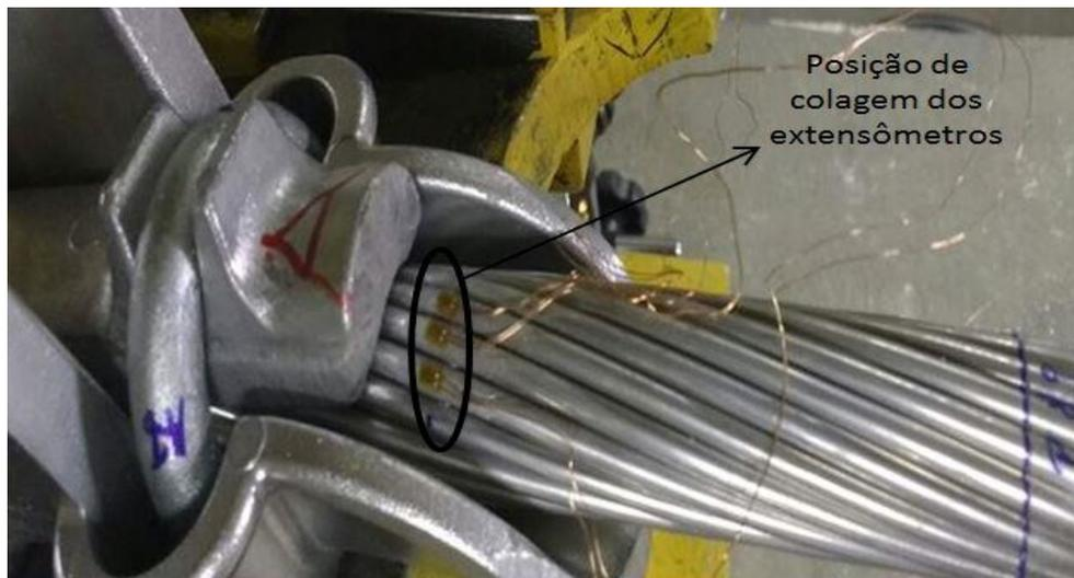
Figura 4.12 – Extensômetros colados no ponto oposto ao UPC e conector sindal
