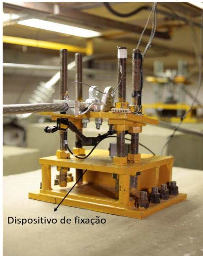
Figura 4.6 – Dispositivo para fixação do grampo de suspensão
