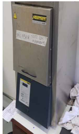
Figura 3.1: Forno Nabertherm utilizado nos tratamentos térmicos de normalização dos corpos de prova.
