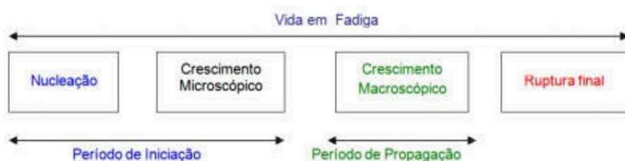
Figura 2.13 – representação gráfica dos estágios do processo de fadiga (FADEL, 2010)
