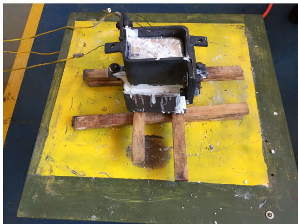
Figura 3.3 – liga vertida na lingoteira
