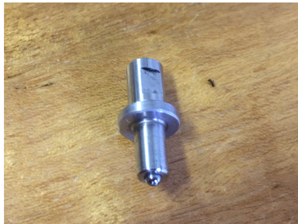
Figura 3.17 – penetrador esférico de 2.5 mm de diâmetro
