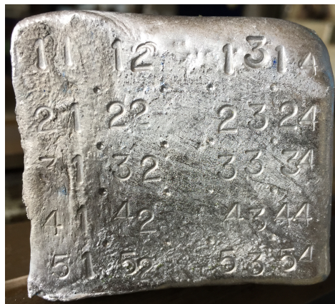
Figura 3.5 – vista frontal do lingote, com as marcações de identificação da posição dos corpos de prova
