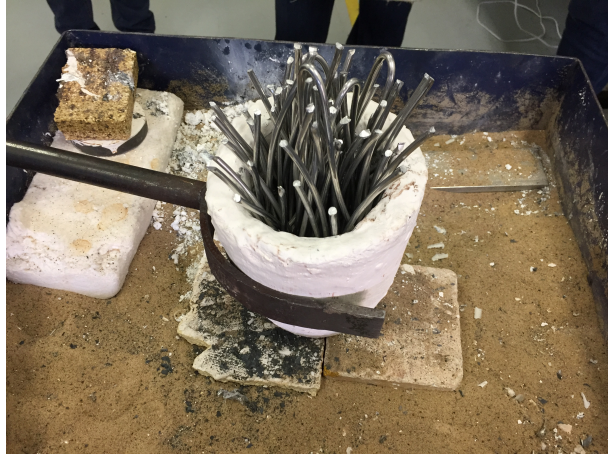
Figura 3.1 – fios do cabo colocados no cadinho de grafite revestido com “alumina”
