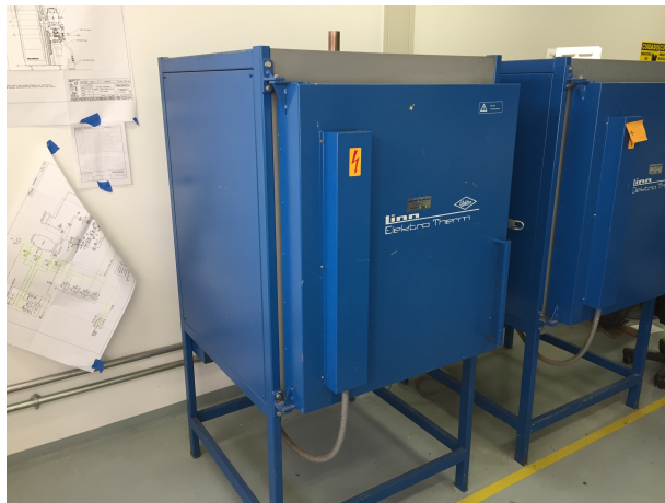
Figura 3.2 – forno tipo mufla, fabricante Linn High Therm
