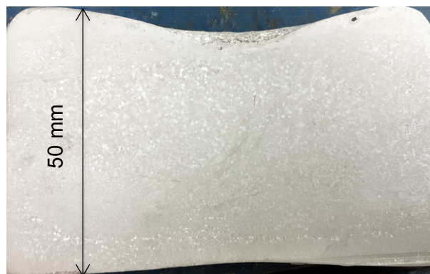
Figura 4.4 – macroestrutura do lingote fabricado em laboratório
