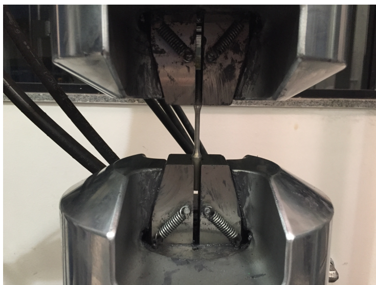
Figura 3.20 – corpo de prova durante ensaio de fadiga
