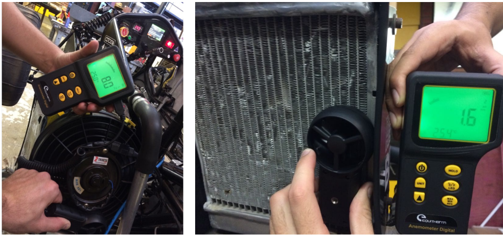
Figura 6.6: Velocidade do ar medida com o auxílio de um anemômetro.
