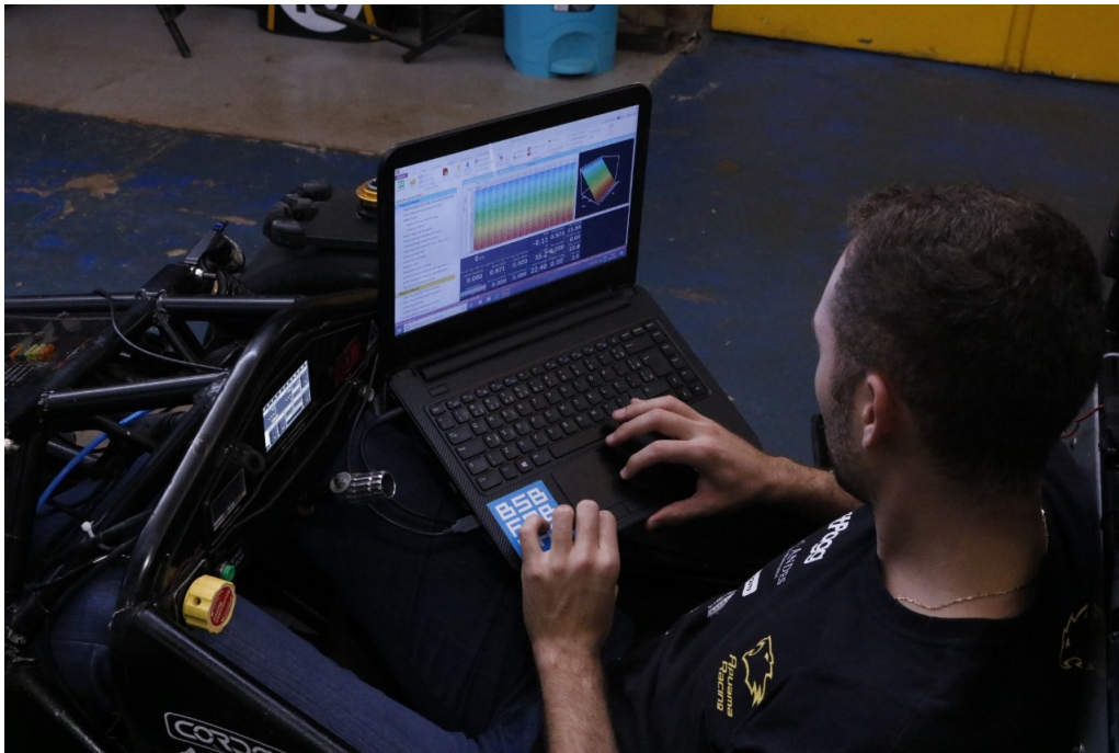
Figura 5.14: Tela do Módulo FT500 mostrado à esquerda da foto instalado no painel do AF18.
