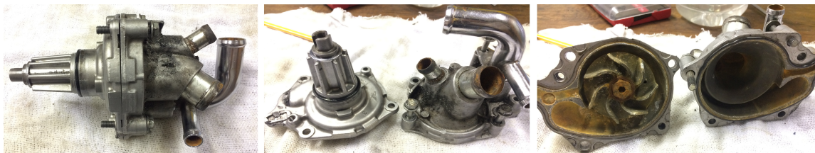
Figura 5.6: Bomba d'água utilizada no motor Honda CB600f.
