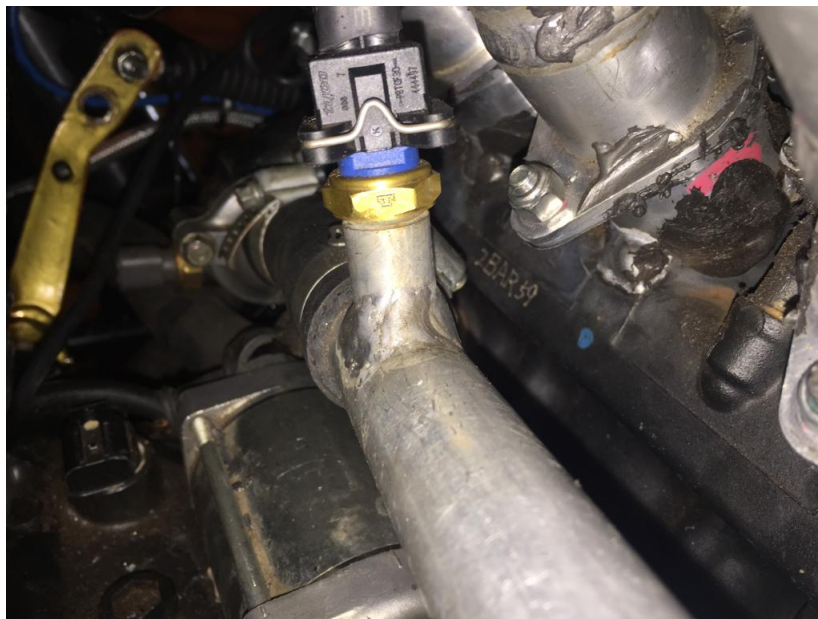
Figura 5.11: Tubo com sensor de temperatura localizado na saída da linha de água do motor.
