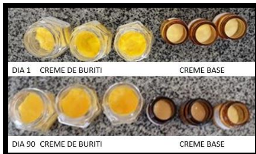
Figura 6: Fotografias ilustrativas das emulsões com e sem óleo de Buriti nos dias 1 e 90 do estudo de estabilidade acelerada (40°C/75%UR). FONTE: próprio autor.
