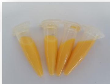
Figura 5: Fotografia ilustrando estabilidade física da emulsão contendo óleo de Buriti após teste de centrifugação (3000 rpm/30min.). FONTE: Próprio autor
