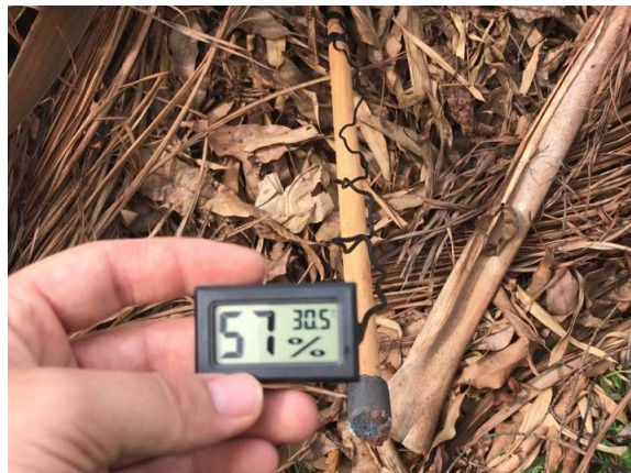
Figura 15 - Monitoramento na fase inicial, leitura de 57% de umidade e temperatura 30,5 °C Fonte: CMB
