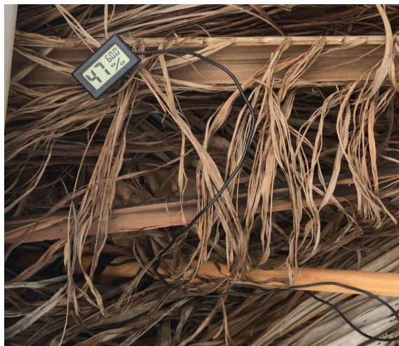
Figura 16 - Monitoramento na fase termofílica, leitura de 47% de umidade e temperatura 60 °C 46 Fonte: CMB
